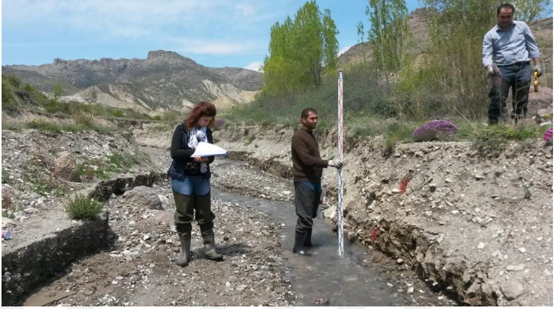
Şekil 4. Olur Mikro Havzasında Dere Kenarı/Şev Yüksekliğinin Mira Yardımıyla Ölçümü
