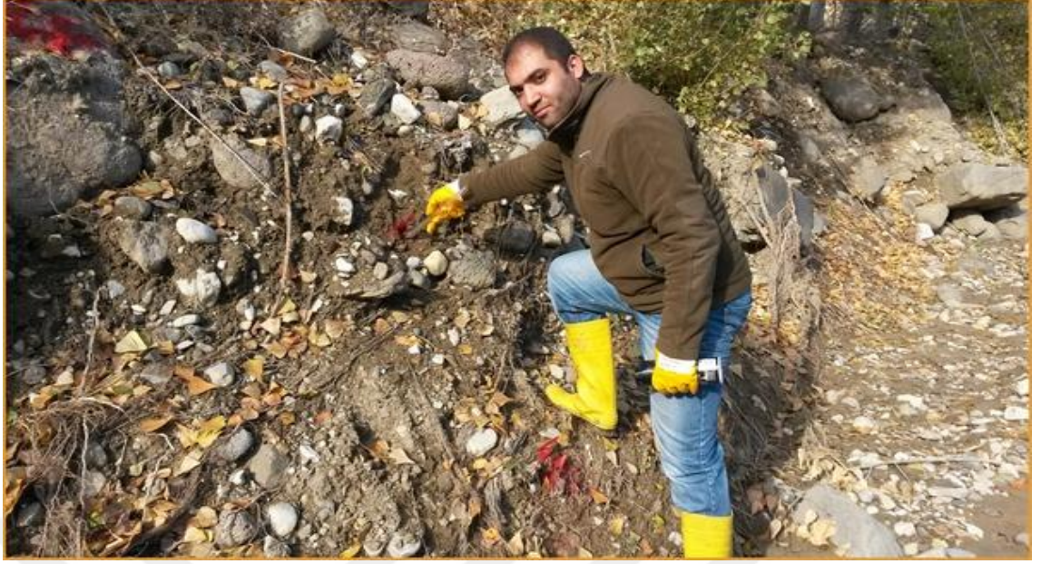
Şekil 3. Olur Mikro Havzasında Sağ Ve Sol Şevlere Konuşlandırılan Erozyon Çubuklarının Cetvel İle Ölçümü
