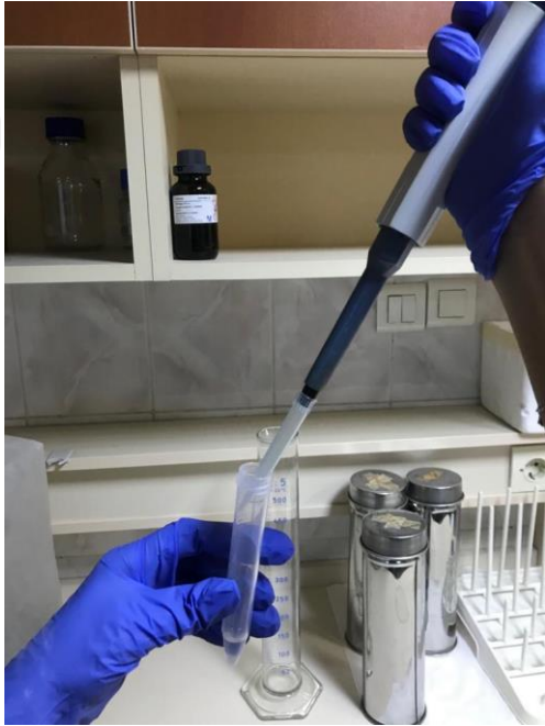
Şekil 3.5. Absolü etanolün %10'a seyreltilmesi.
