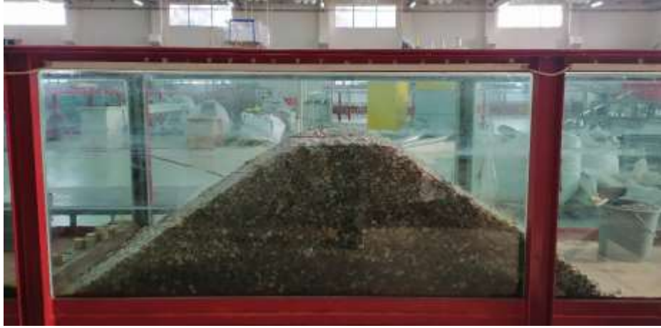
Şekil 5.6 Dalgakıran modeline ait çekirdek tabakası
