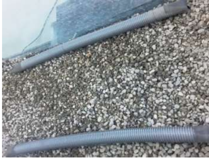
Şekil 5.4 Dalgakıran modeli çekirdek tabakası filtre borusu
