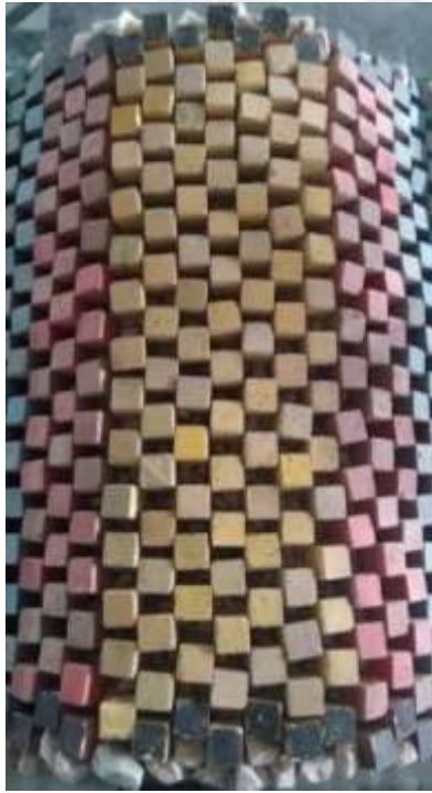
Şekil E.3 7D_n \Psi_s=0.59 sıkılıkta ön şevde küp bloklarda hasar. a) Kesitin ilk hali, b) Hasar sonrası
