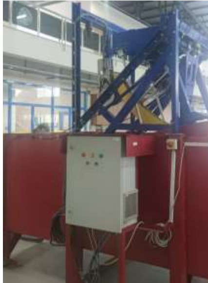
Şekil 5.15 Dalga üretici görünümü
