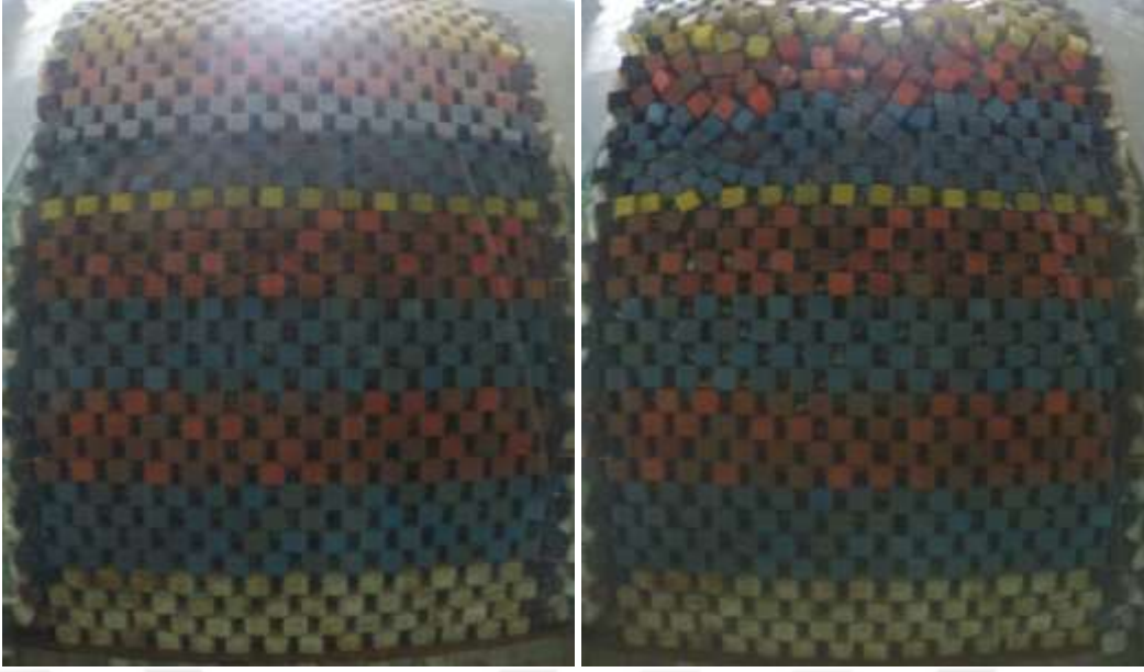
Şekil E.3 7D_n \Psi_s=0.59 sıkılıkta ön şevde küp bloklarda hasar. a) Kesitin ilk hali, b) Hasar sonrası
