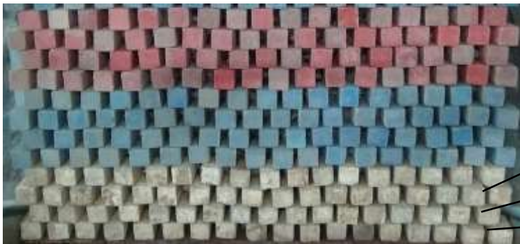
Şekil 5.12 Farklı sıklıklara ait modellerde küp dizilimi. a) 0.59 sıklık, b) 0.67 sıklık.
