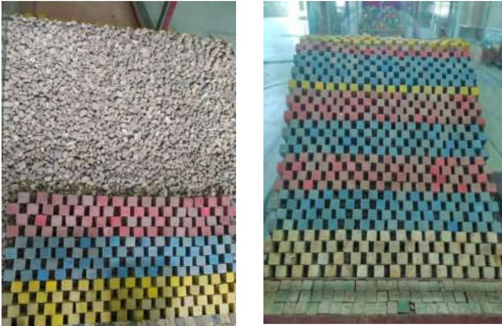
Şekil 5.7 Dalgakıran modeline ait kesitin oluşturulması
