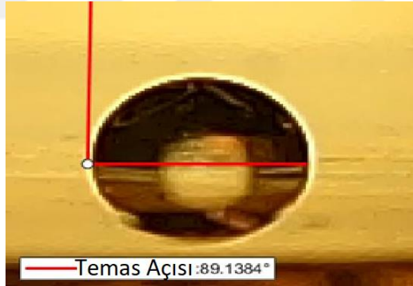
Şekil 3.18: Saf polyester numuneye ait örnek temas açısı ölçümü.
