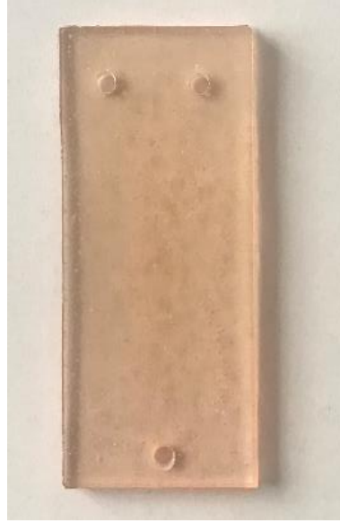
Şekil 3.7: Eğik düzlem testinde test edilmeye hazır bir numune.
