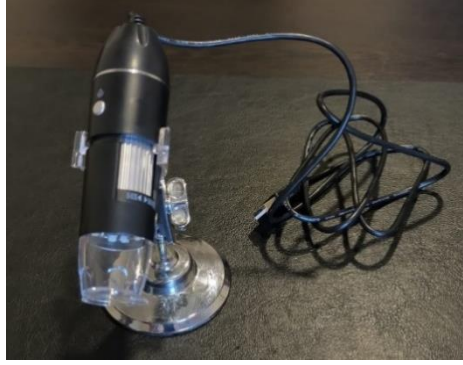
Şekil 4.1: Boyut ölçümünde kullanılan dijital mikroskop.
