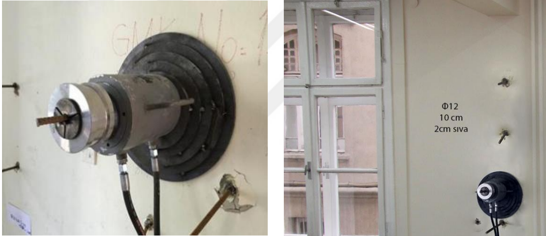
Şekil 5. Kısmi Sıyırılma Deney Düzeneği Görünüşleri
