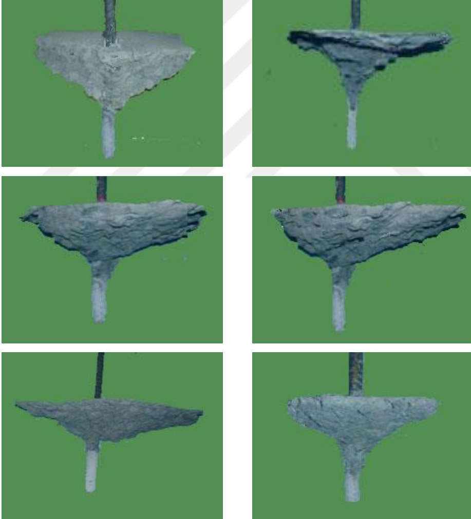
Şekil 9. Göçme Sonrası Ankraj Demiri Görünümleri
