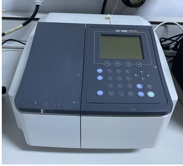
Şekil 3.2 Shimadzu UV-1800 kararlı durum soğurma spektrometresi
