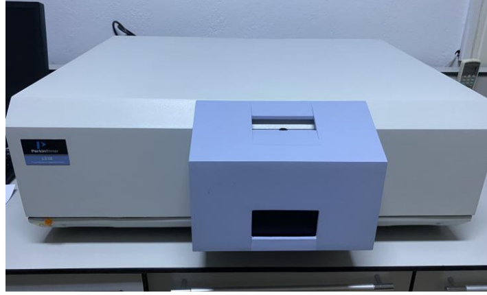
Şekil 3.3 Perkin Elmer LS55 floresans spektrometresi
