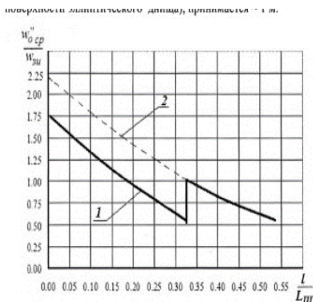
Рис. 14. Распределение скоростей пара, приведенных к поверхности зеркала испарения, по длине пучка: 1 – без учета подвода питательной воды, 2 – с учетом подвода питательной воды
