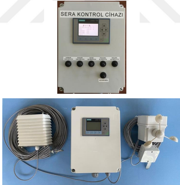
Şekil 3.5 Siemens sera iklim kontrol ünitesi (Anonymous. 2024o) ( https://www.amazon.de/-/en/Siemens-6ED1052-1MD08-0BA1-PLC-Control-Module/dp/B097C48MSG )
