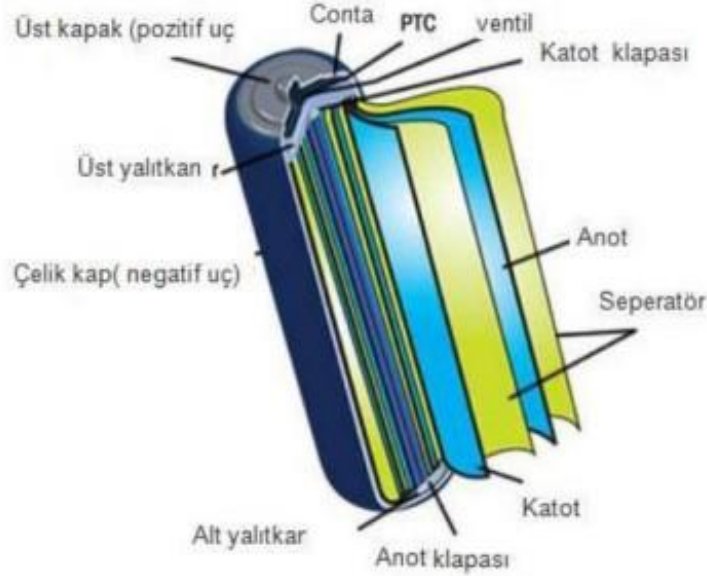
Şekil 1711: Lityum İyon Pil Kesiti
