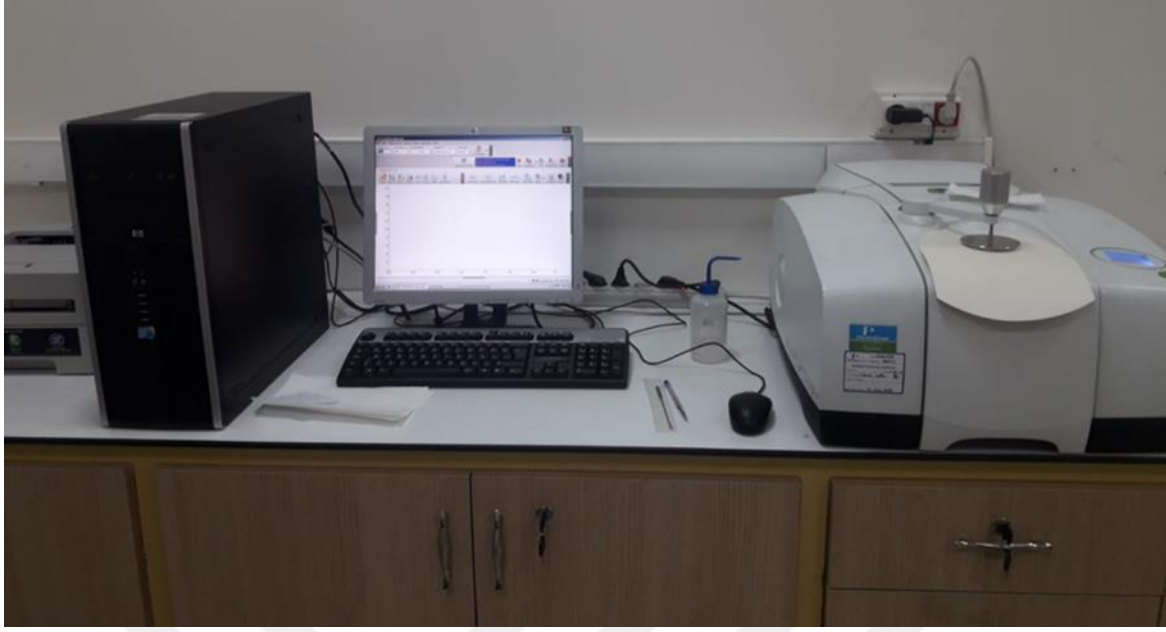
Resim 3.8. FTIR analizinin yapıldığı cihaz
