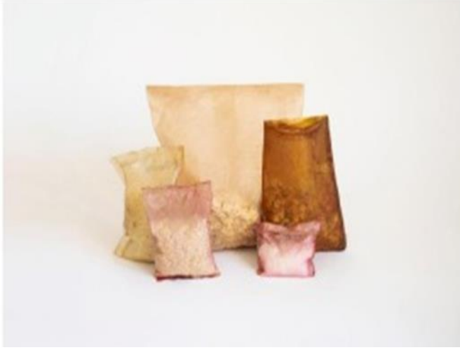
Resim 1.9. Bakteriyel selülozun gıda ambalajı olarak kullanılması (Du ve diğerleri, 2020).
