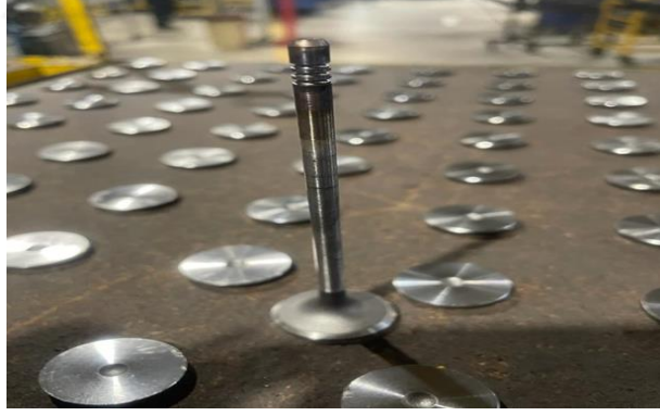
Resim 1.9 Uç kısmı sertleştirilmiş supap.
