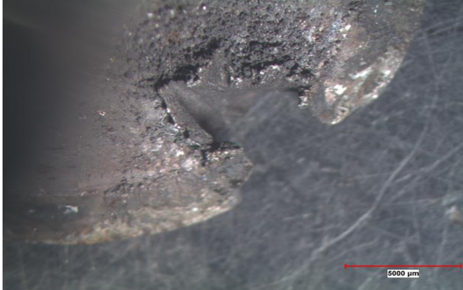
Resim 3.16 C kodlu arızalı supap (hasarlı bölge).
