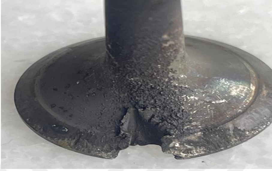
Resim 3.13 C kodlu arızalı supap (hasarlı bölge).
