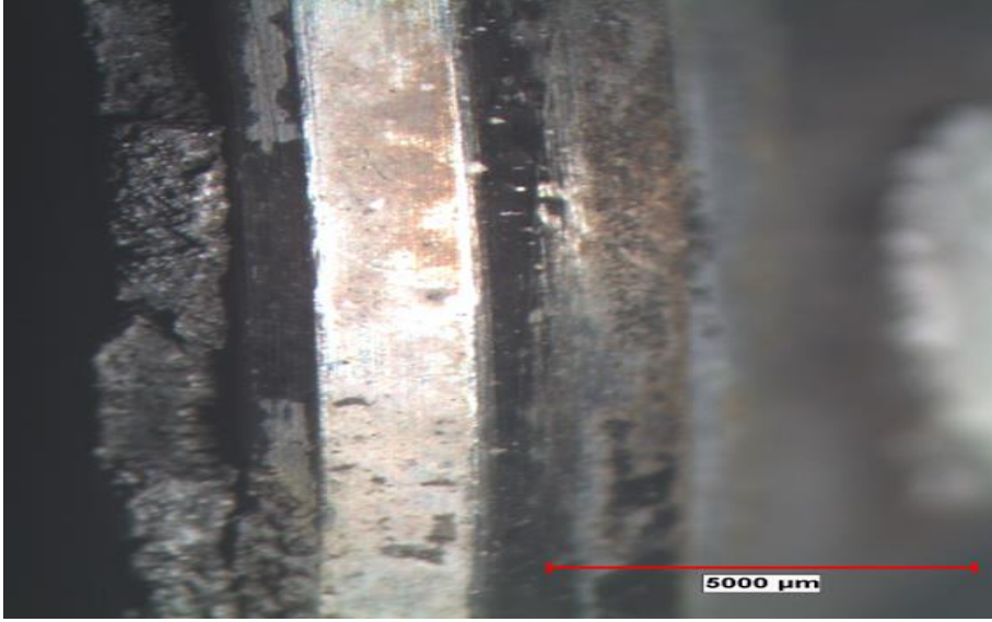
Resim 3.10 B kodlu arızalı supap yan görünüşü.
