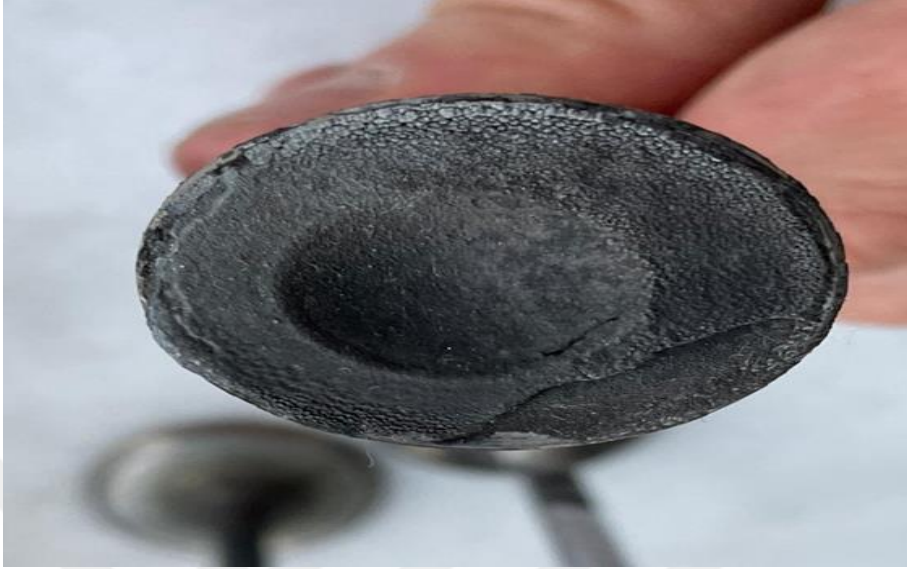
Resim 3.7 B kodlu arızalı supap (Şapka Arkası).
