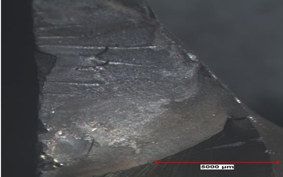
Resim 3.4 A kodlu arızalı supap stereo mikroskop görüntüsü (hasarlı bölge).
