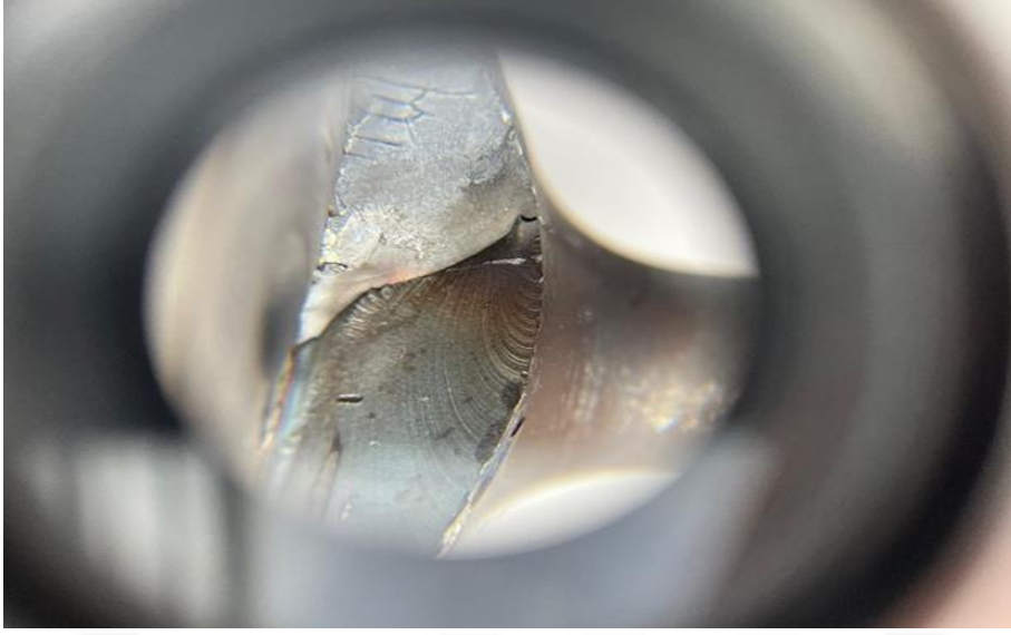
Resim 3.3 A kodlu arızalı supap (hasarlı bölge).
