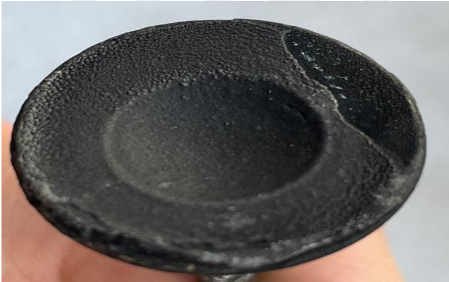
Resim 3.8 B kodlu arızalı supap (Şapka Arkası).
