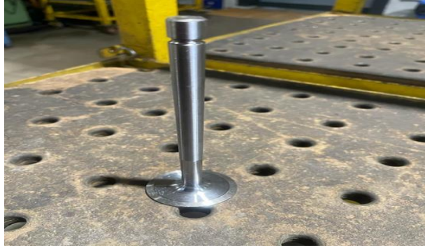
Resim 1.6 Sap yüzeyi taşlanmış supap.
