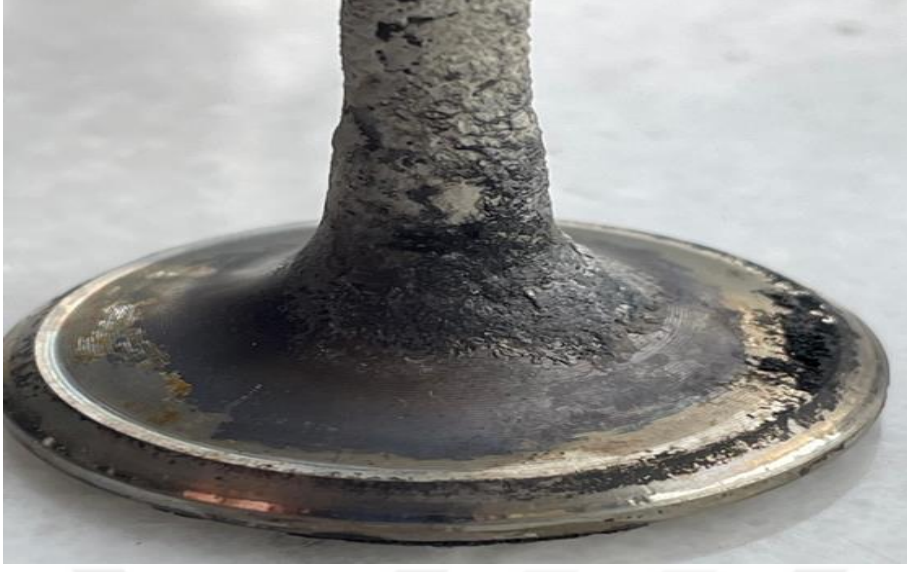
Resim 3.9 B kodlu arızalı supap (Sap ve Radyüs).
