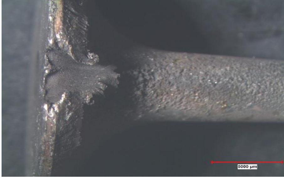
Resim 3.15 C kodlu arızalı supap (hasarlı bölge).
