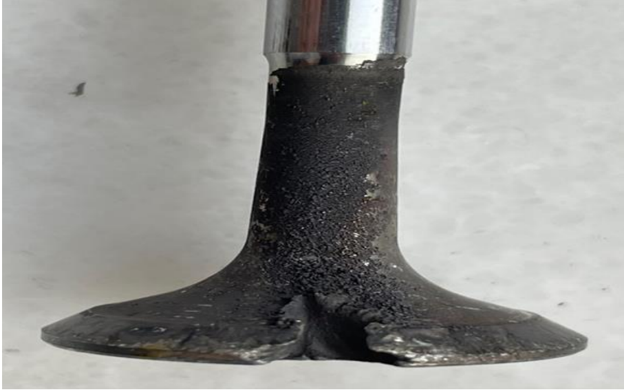
Resim 3.14 C kodlu arızalı supap (hasarlı bölge).
