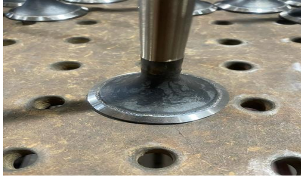
Resim 1.7 Açılı taşlanmış supap.
