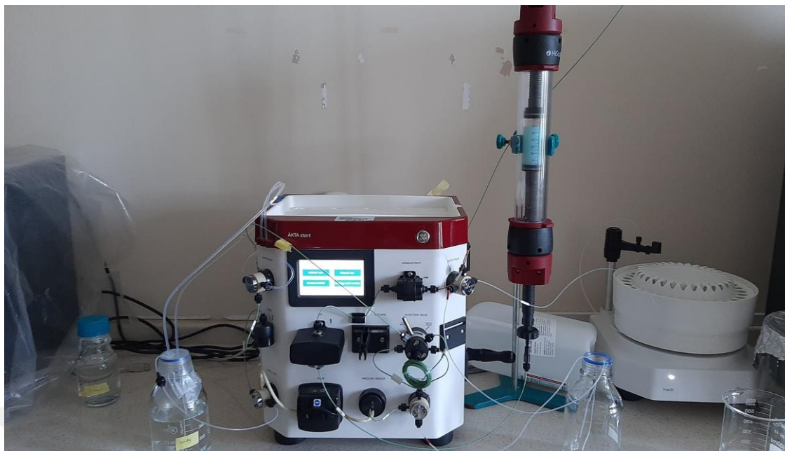
Figure 3.2. ÄKTA Start system
