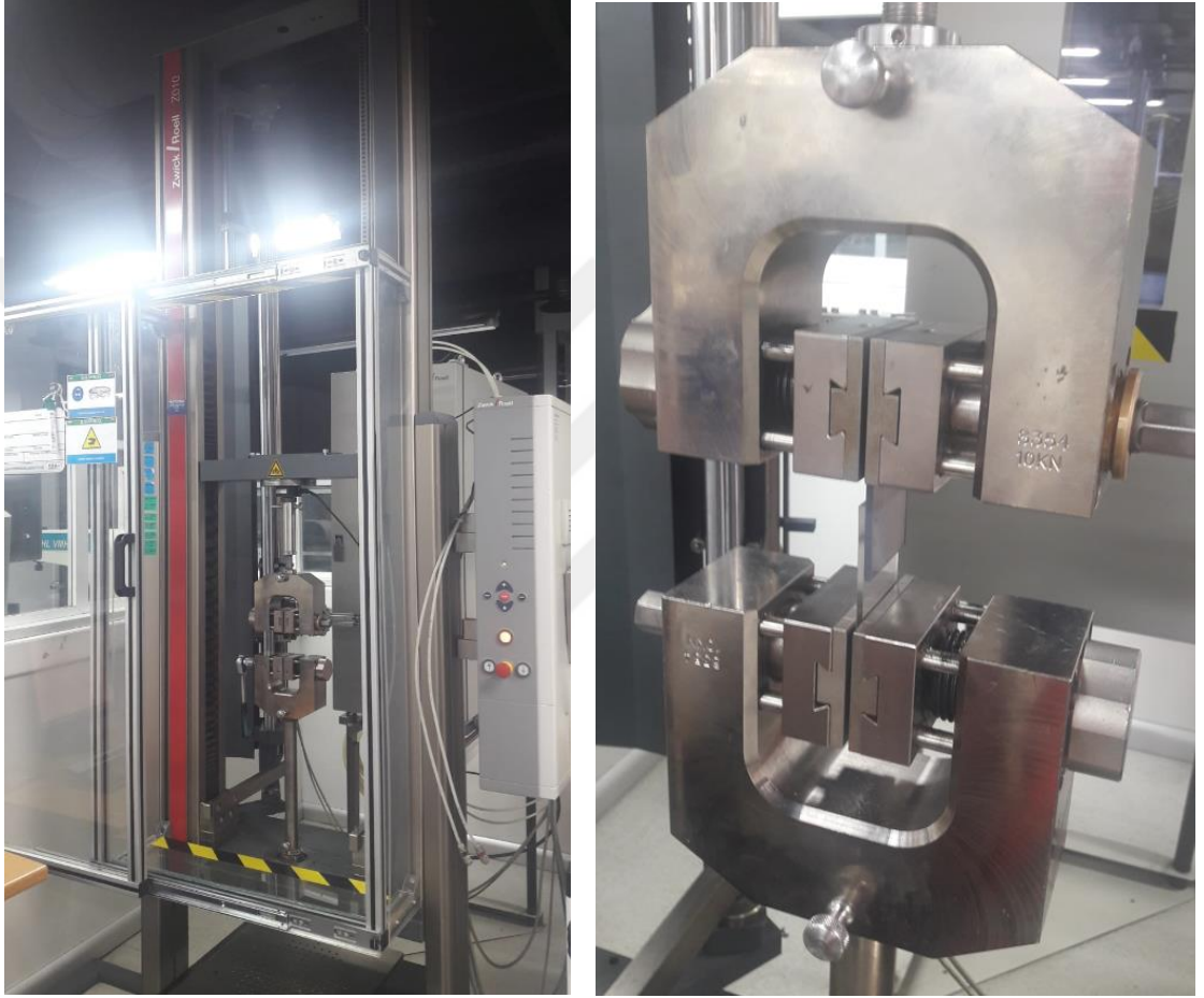
Şekil 3.8. Zwick/Roell Z010 makinesinde numune çekme testi gösterimi
