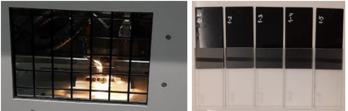
Şekil 3.7. Numunelerin kaynak anı ve kaynak parçaların gösterimi
