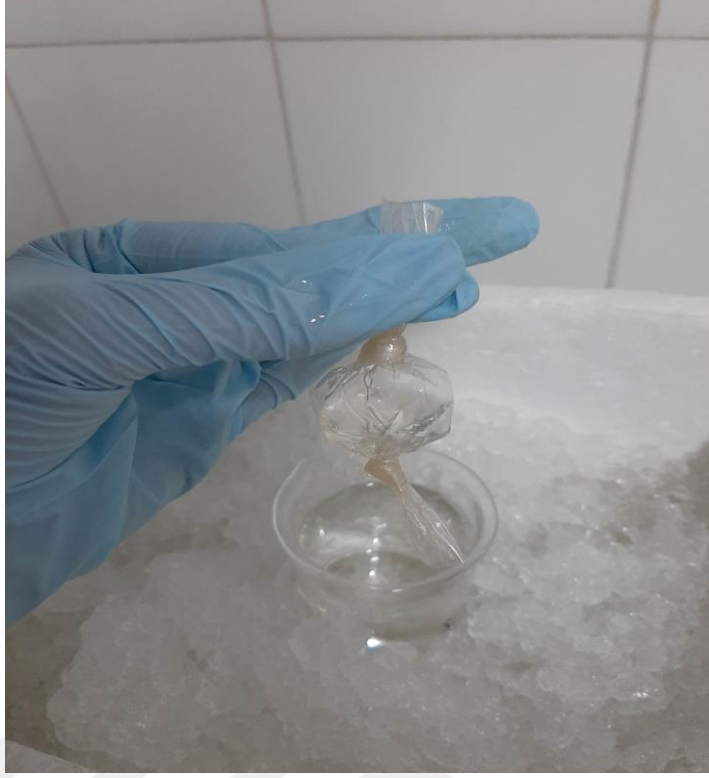
Şekil 3.7. Diyaliz Membranına Örnek Yerleştirilmesi
