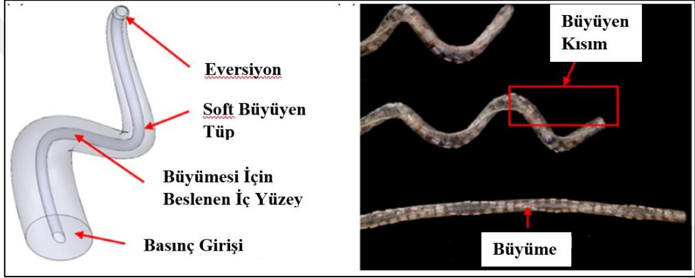
Şekil 2.2.1.2.1. Soft Büyüyen Sürekli Robot
