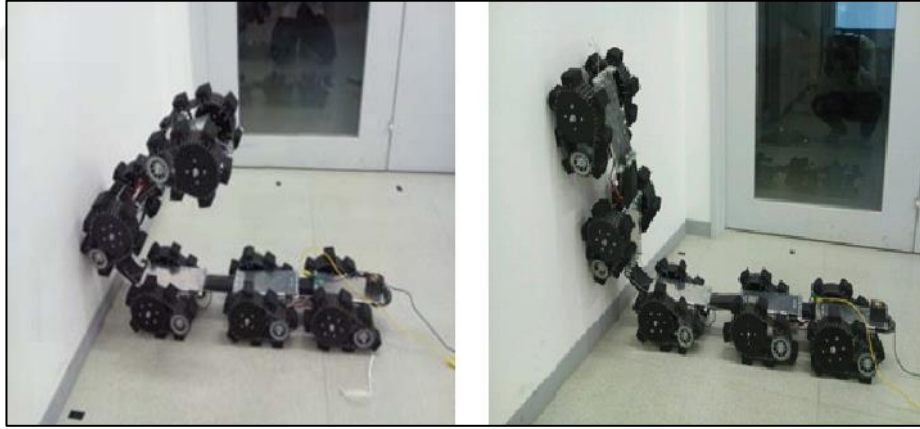
Şekil 2.1.11. Stabilizasyon Sistemine Sahip Arama Kurtarma Robotu (Kawai ve ark., 2014)
