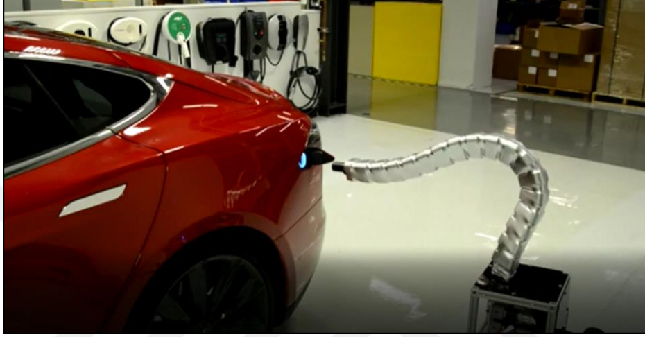
Şekil 2.1.12. Tesla İnsansız Araç Şarj Robotu (CBC, 2015)
