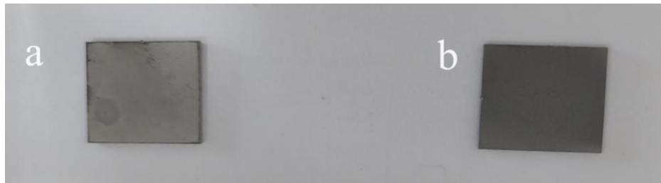
Resim 3.2 Deneysel çalışmalarda kullanılan levhalar, ( a: Taşlanmamış numune, b: Taşlanmış numune)
