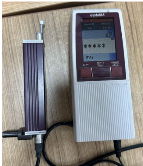
Resim 3.10 Yüzey pürüzlülük testi cihazı
