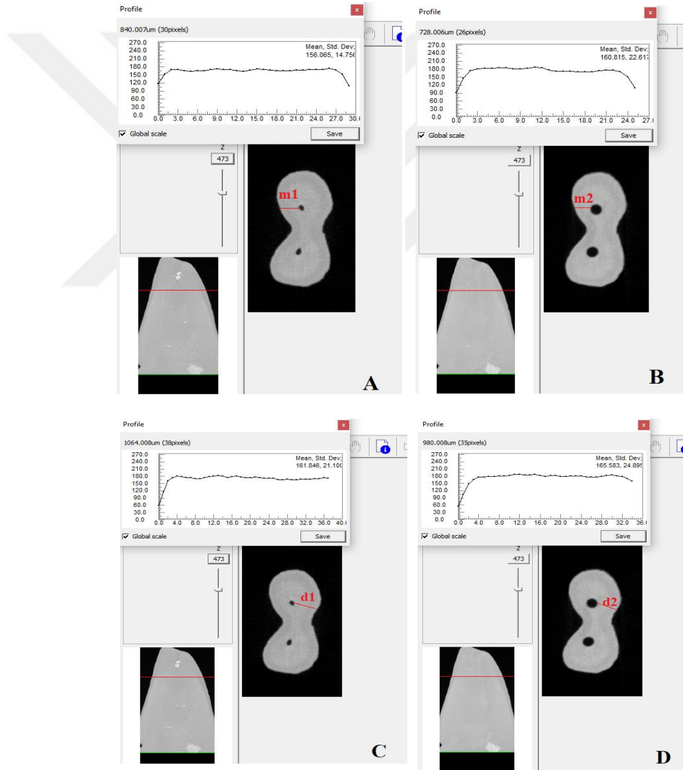
Şekil 3.17. Data Viewer yazılımında (m1-m2) - (d1-d2) formülü ile transportasyon miktarının hesaplanması [A) m1 B) m2 C) d1 D) d2].
