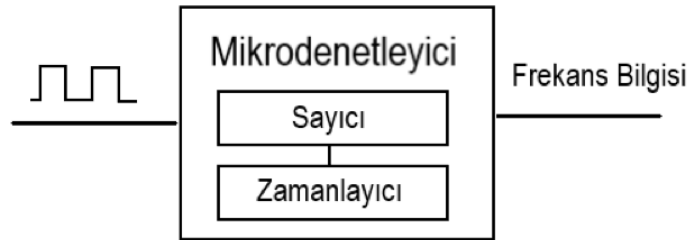
Şekil 2.10. Gerçekleştirilen frekans ölçümüne ait blok şeması (Shao, 2022).
