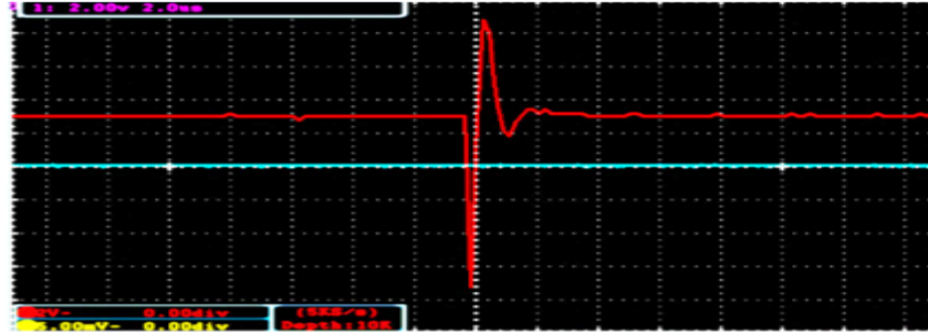
(a) Uygulanacak olan Surge test sinyali.
