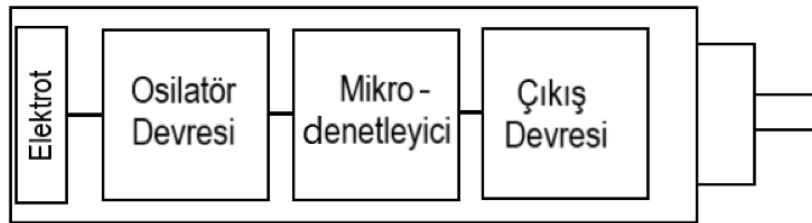
Şekil 2.1. Tasarlanan sensörün blok diyagramı (Salila Vijayalal Mohan ve Malcolm, 2021).
