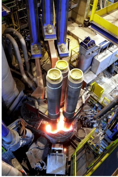
Şekil 2.3. Elektrotlar yardımıyla pota ısıtma işlemi
