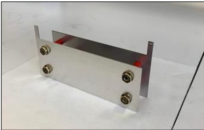
Şekil 3.20. 5 cm aralıkla birleştirilmiş elektrotlar (Anot ve Katot)
