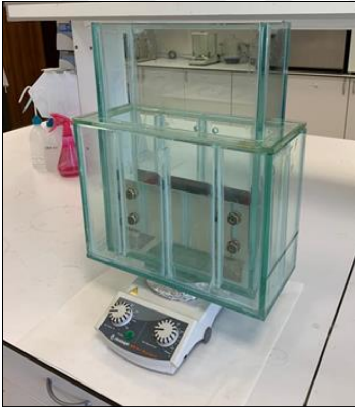
Şekil 3.22. EK sistemine manyetik karıştırıcının entegre edilmiş görseli
