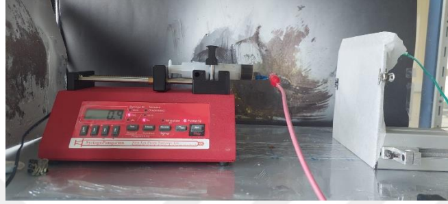
Şekil 8. IBU-PCL Partiküllerin Elektro Püskürtme Yöntemiyle Üretilmesi
