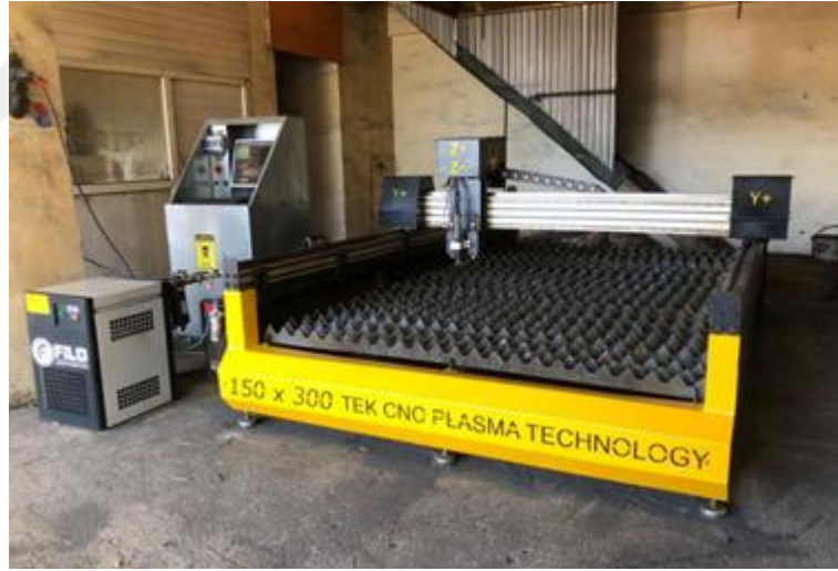
Şekil 3.52 1500x3000 mm işleme alanına sahip tasarlanan CNC plazma kesim tezgâhı - imalatı
