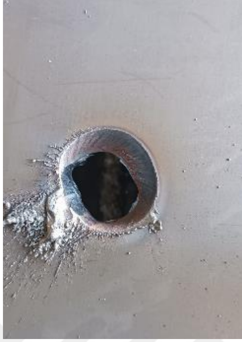
Şekil 4.1 Hız ve amper ayarının hatalı yapılması sonucu kesilen 15 mm kalınlığında - St37 malzeme
