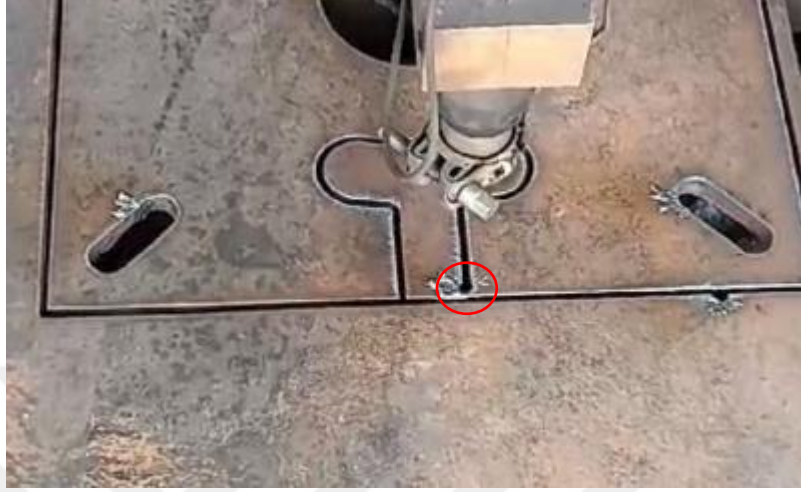
Şekil 4.23 CNC plazma kesim tezgâhında oluşan arıza sonucu hatalı kesim
