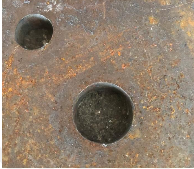
Şekil 4.2 Amper hız ayarı tespit edildikten sonra 15 mm kalınlığındaki St37 - malzemenin kesimi
