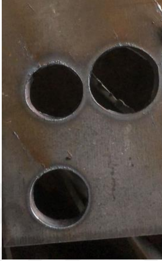
Şekil 4.18 Mekanik arıza sonucu CNC plazma kesim tezgâhında hatalı kesim işlemi
