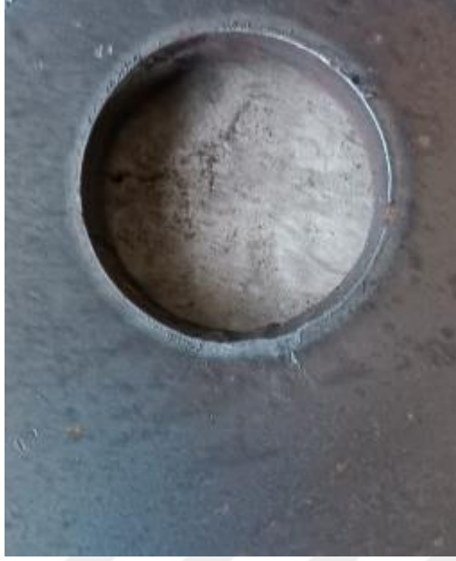
Şekil 4.19 Arızanın giderilmesi sonucunda CNC plazma kesim tezgâhında kesim işlemi
