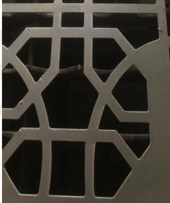
Şekil 4.22 CNC plazma kesim tezgâhında arızanın giderilmesi örnek kesim
