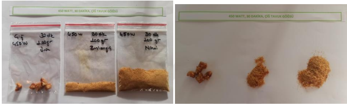
Mikrodalga 450 W 30 dakika Çiğ Tavuk Eti (1-Sistemde kurutulan ürün; 2- blender sonrası ürün; 3,nem tayin cihazından çıkan ürün)
