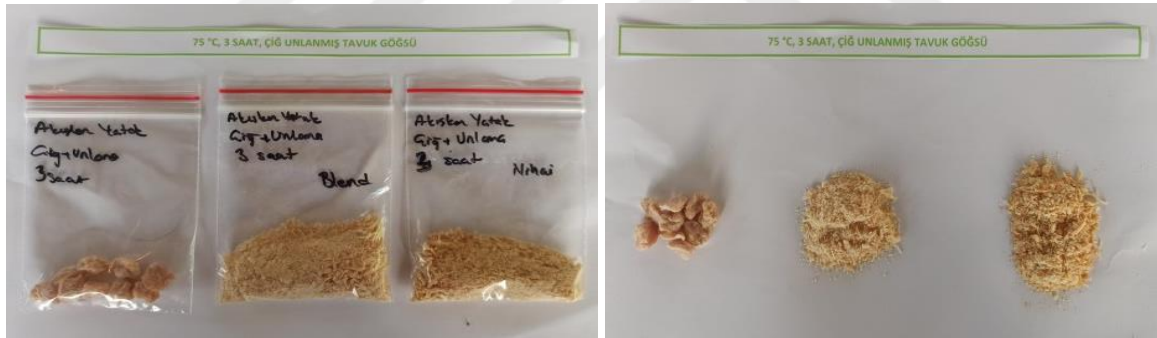
Akışkan Yatak 75 °C 3 Saat Unlanmış Çiğ Tavuk Eti (1-Sistemde kurutulan ürün; 2- blender sonrası ürün; 3,nem tayin cihazından çıkan ürün)
