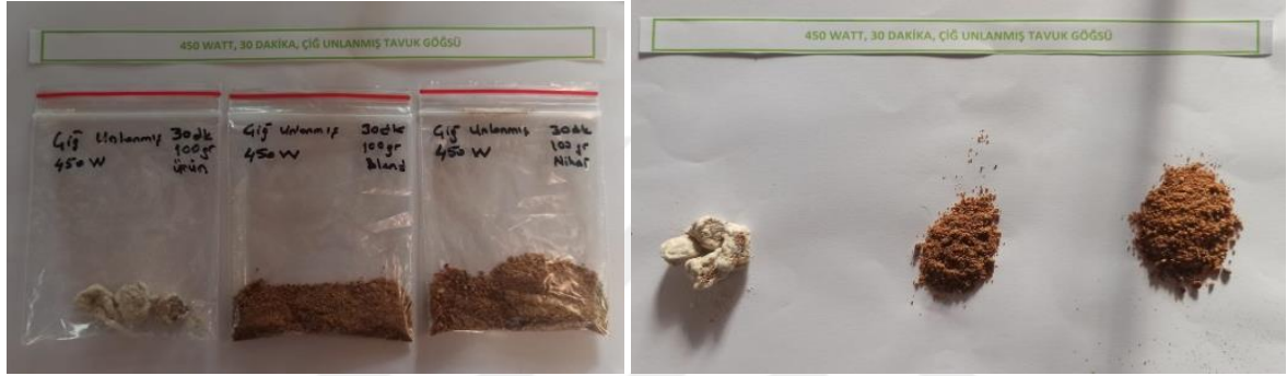
Mikrodalga 450 W 30 dakika Unlanmış Çiğ Tavuk Eti (1-Sistemde kurutulan ürün; 2- blender sonrası ürün; 3,nem tayin cihazından çıkan ürün)
