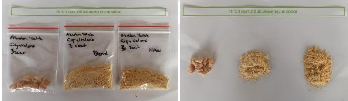
Akışkan Yatak 75 °C 3 Saat Haşlanmış Tavuk Eti (1-Sistemde kurutululan ürün; 2- blender sonrası ürün; 3,nem tayin cihazından çıkan ürün)
