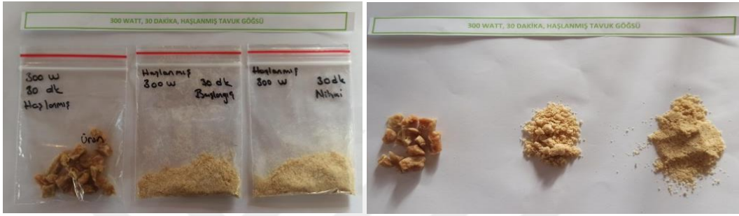
Mikrodalga 300 W 30 dakika Haşlanmış Tavuk Eti (1-Sistemde kurutulan ürün; 2- blender sonrası ürün; 3,nem tayin cihazından çıkan ürün)
