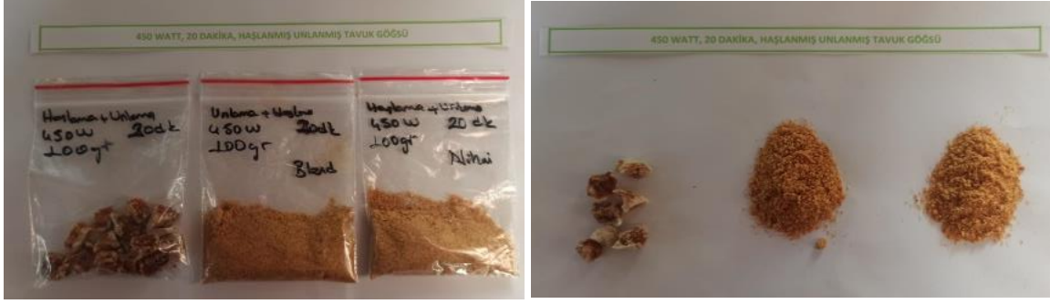
Mikrodalga 450 W 20 dakika Unlanmış Haşlanmış Tavuk Eti (1-Sistemde kurutulan ürün; 2- blender sonrası ürün; 3,nem tayin cihazından çıkan ürün)
