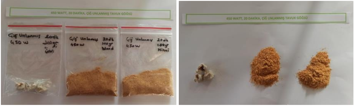
Mikrodalga 450 W 20 dakika Unlanmış Çiğ Tavuk Eti (1-Sistemde kurutulan ürün; 2- blender sonrası ürün; 3,nem tayin cihazından çıkan ürün)
