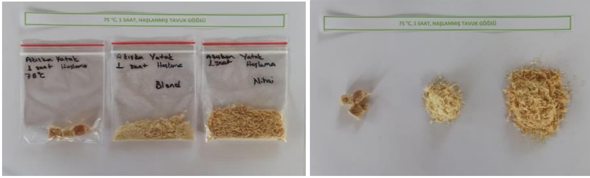
Akışkan Yatak 75 °C 1 Saat Haşlanmış Tavuk Eti (1-Sistemde kurutululan ürün; 2- blender sonrası ürün; 3,nem tayin cihazından çıkan ürün)
