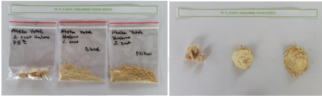
Akışkan Yatak 75 °C 2 Saat Haşlanmış Tavuk Eti (1-Sistemde kurutululan ürün; 2- blender sonrası ürün; 3,nem tayin cihazından çıkan ürün)
