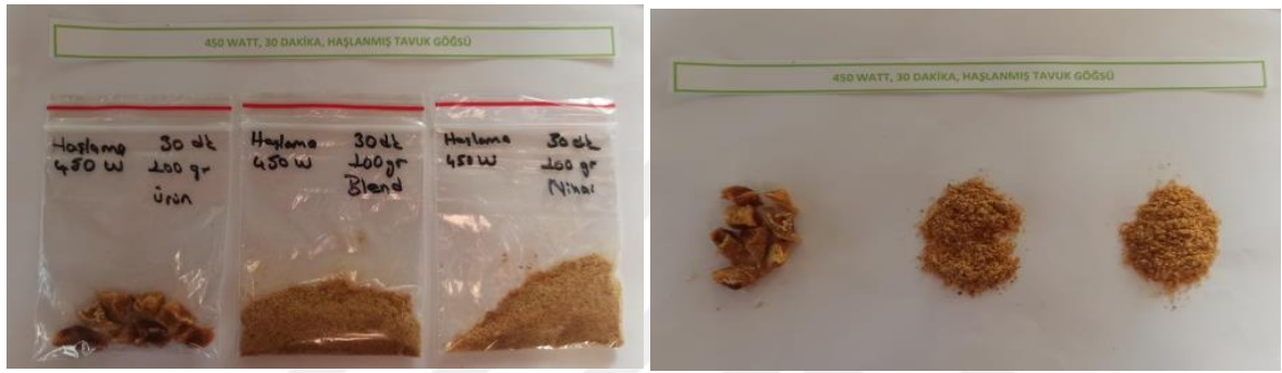
Mikrodalga 450 W 30 dakika Haşlanmış Tavuk Eti (1-Sistemde kurutulan ürün; 2- blender sonrası ürün; 3,nem tayin cihazından çıkan ürün)
