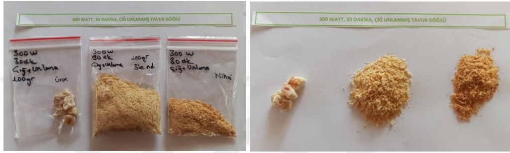
Mikrodalga 300 W 30 dakika Unlanmış Çiğ Tavuk Eti (1-Sistemde kurutulan ürün; 2- blender sonrası ürün; 3,nem tayin cihazından çıkan ürün)
