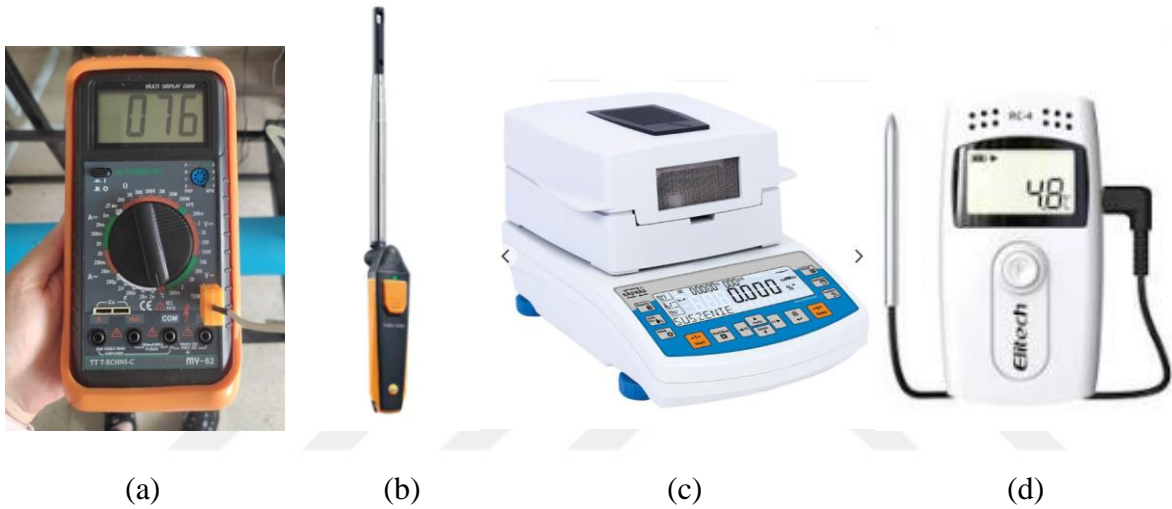
Şekil 5.5 Ölçme aletleri (a): Multimetre; (b): Anemometre; (c): Nem tayin cihazı (d): Nem sıcaklık ölçer.
