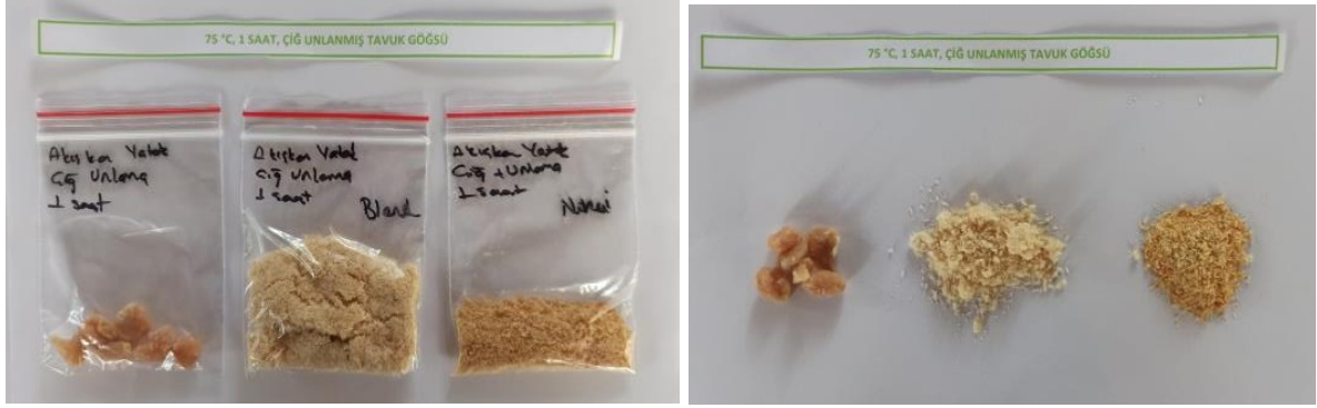
Akışkan Yatak 75 °C 1 Saat Unlanmış Çiğ Tavuk Eti (1-Sistemde kurutulan ürün; 2- blender sonrası ürün; 3,nem tayin cihazından çıkan ürün)
