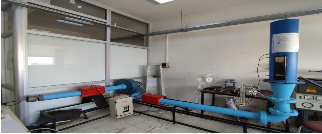
Şekil 5.8 (b) Kullanılan akışkan yatak mekanizması.
