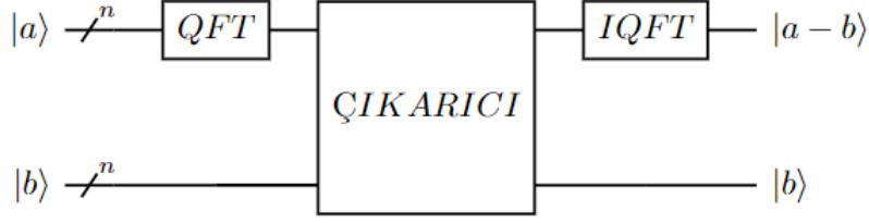
Şekil 4.8. QFT tabanlı çıkarıcı devre
