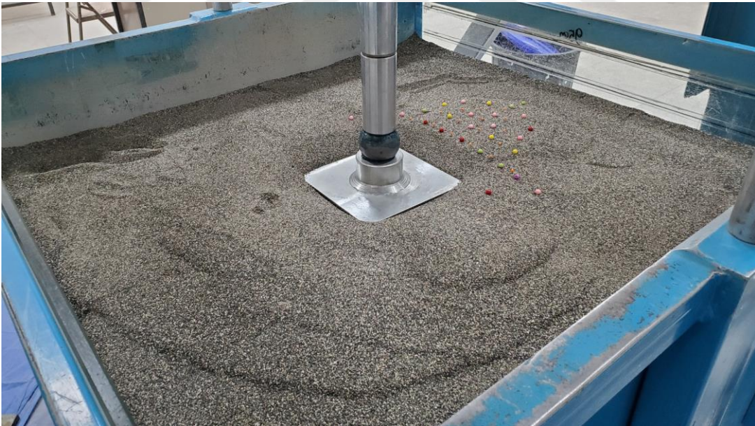
Şekil 5.42. Dr=%65 zemin sıkılığında ve kazısız modelde yükleden dolayı oluşan kabarma ve yayılmalar
