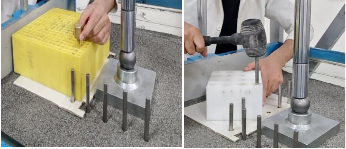
Şekil 5.6. Kılavuz başlık ve çakma aparatı kullanımı
