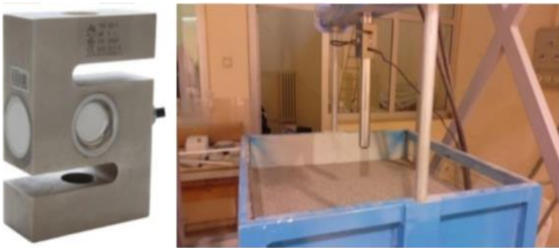
Şekil 5.10. S tipi 5 ton kapasiteli yük hücresi
