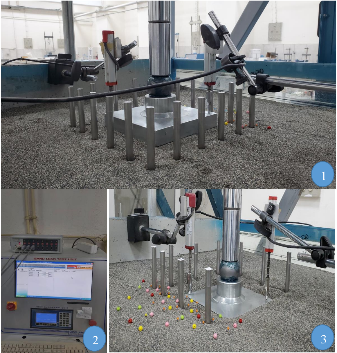
Şekil 5.19. (1) Deney sisteminin düşey yüklemeye hazır hale getirilmesi, (2) yük hücresinden gelen verilerin ekranda gösterilmesi, (3) belirlenen oturma değerine ulaşıldıktan sonra deneyin sonlandırılması
