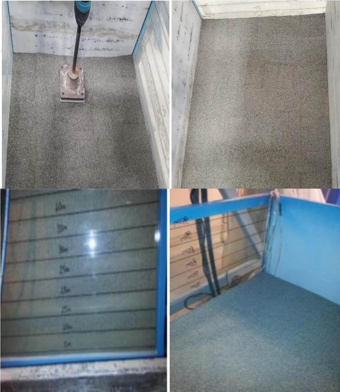
Şekil 5.14. Farklı rölâtif sıklıklardaki zemin tabakalarının oluşturulması
