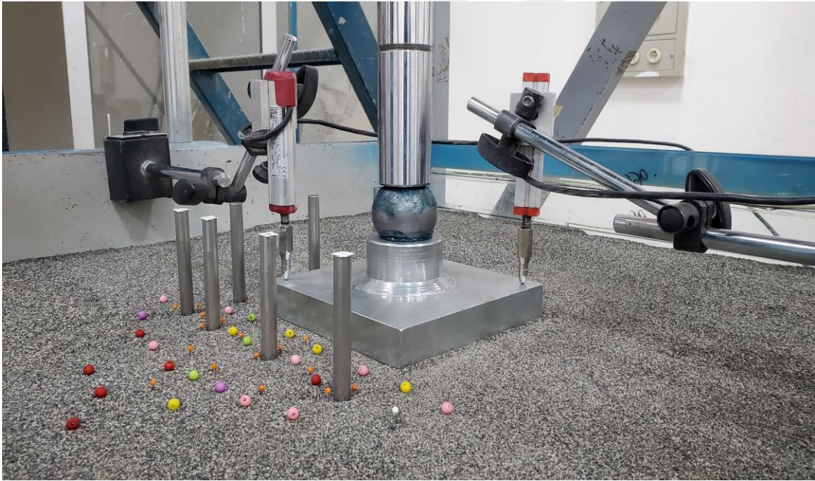
Şekil 5.13. Deplasman ölçerler (LVDT) ve radye plak üzerine yerleşimleri
