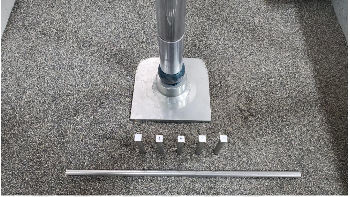
Şekil 5.7. Deneylerde kullanılan çelik kazıklar
