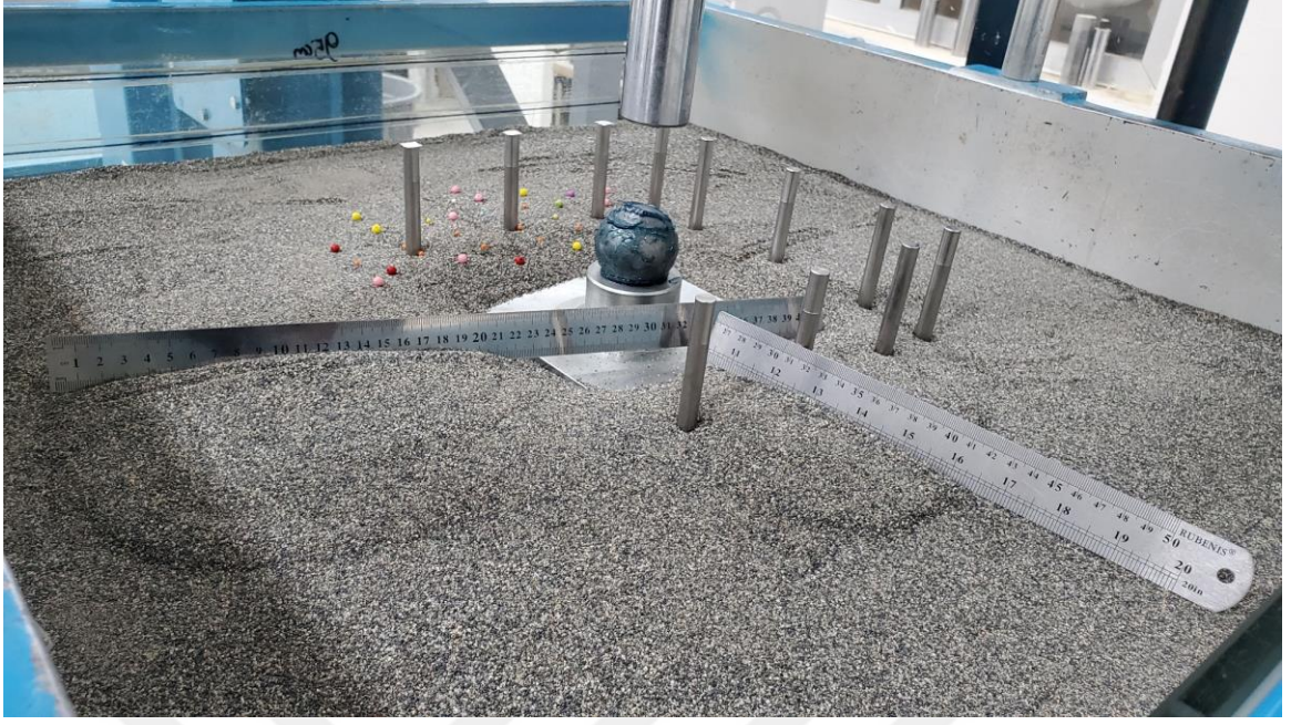
Şekil 5.46. Temel kenarlarına yerleştirilen kazıkların kum yayılmasının önlenmesine etkisi
