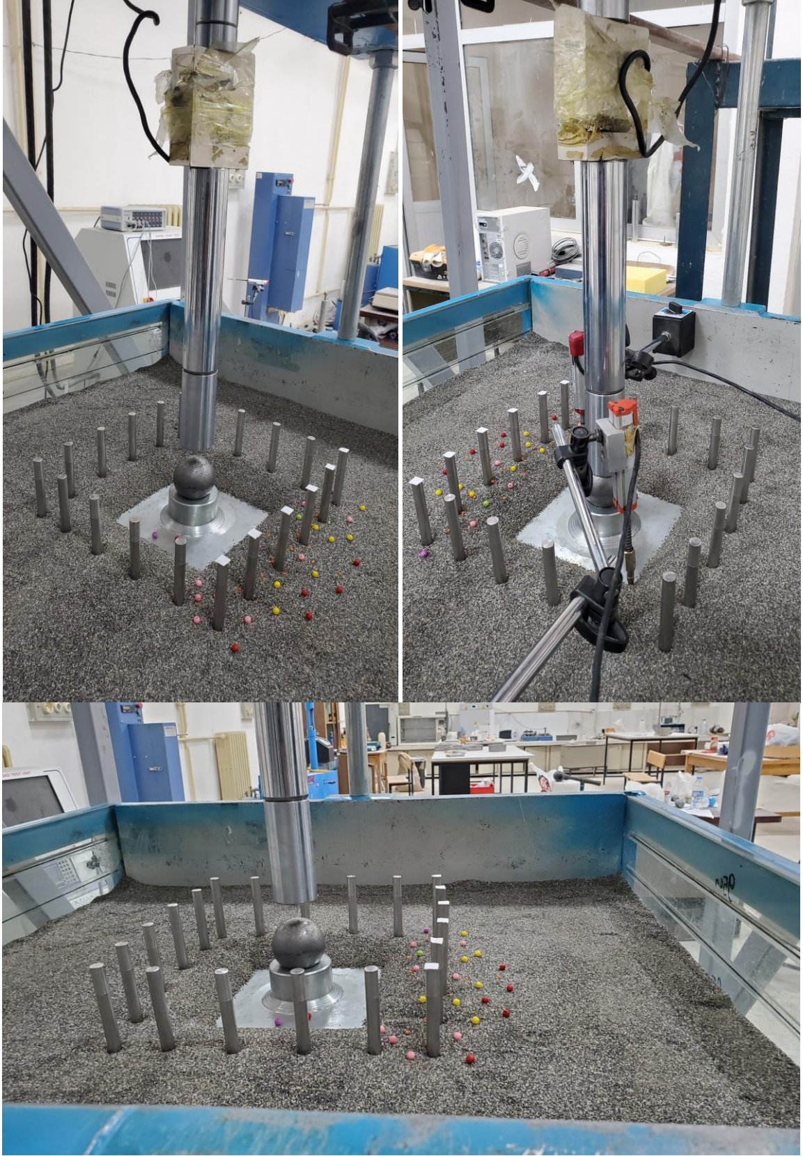
Şekil 5.44. D_r=65\% zemin sıkılığında yüklemeye dolaylı zeminde oluşan kabarma ve yayılmaların önlenmesine 4x4 kazık kombinasyonunun etkisi
