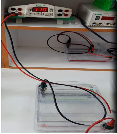
Şekil 3.3 Cuscuta approximata Bab.'ya ait örneklerin elektroforez cihazında koşturulması
