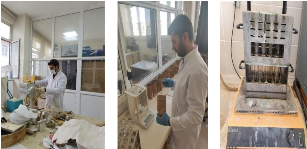
Şekil 3.10 Analizler için öğütme, tartım ve protein analizi için yakma işlemi
