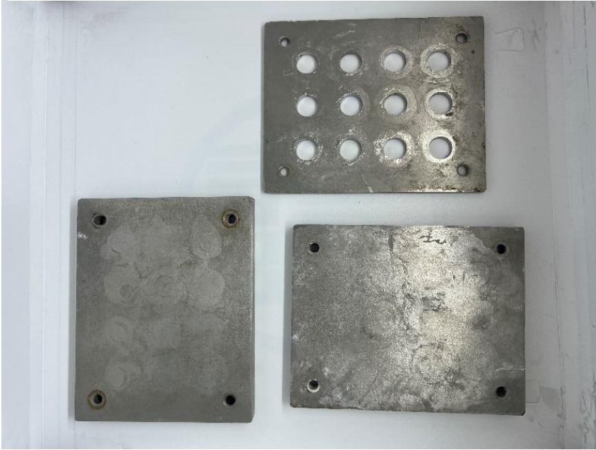
Şekil 3.4: Örneklerin hazırlanmasında kullanılan kalıp
