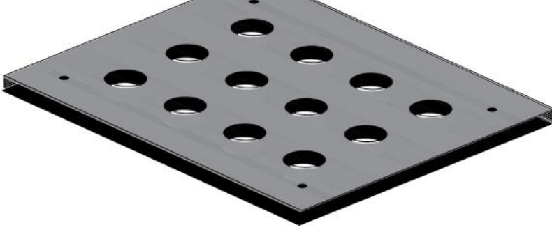
Şekil 3.3: Örneklerin üretimi için kullanılan kalıp tasarımı
