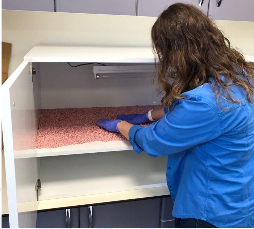
Fotoğraf 3.2. Çalışmada kullanılan ultraviyole uygulama kabini.
