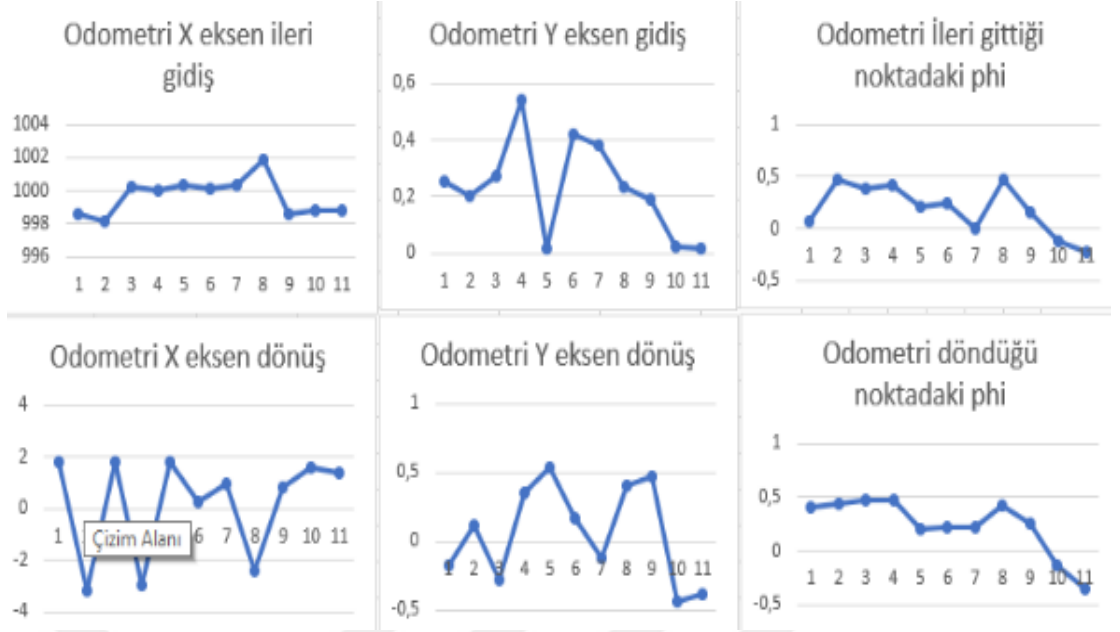
Şekil 4.13 Birinci 1000mm ileri gidiş ve dönüşlerden elde edilen kaçıklıklar
