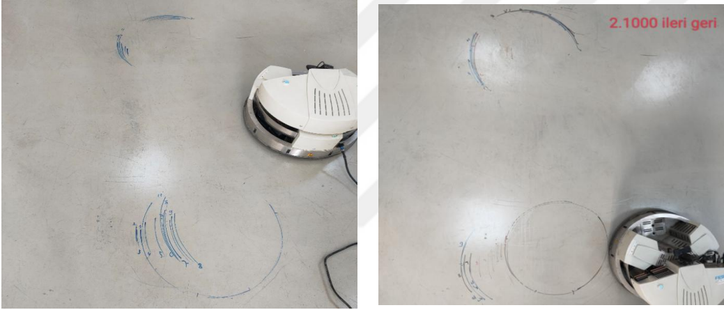
Şekil 4.12 1000 mm ileri gidiş ve dönüşlerden elde edilen kaçıklıklar
