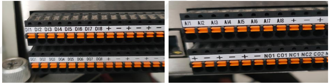
Şekil 3. 2 Robotino robotun dijital ve analog giriş/çıkışları
