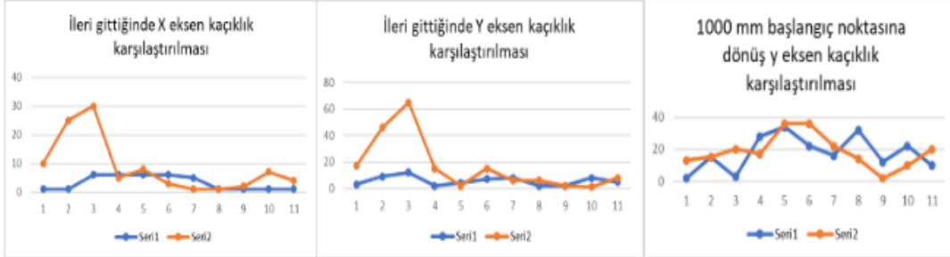
Şekil 4.16 1000mm iki deneme sonucunda Robotino eksen kaçıklık karşılaştırmaları
