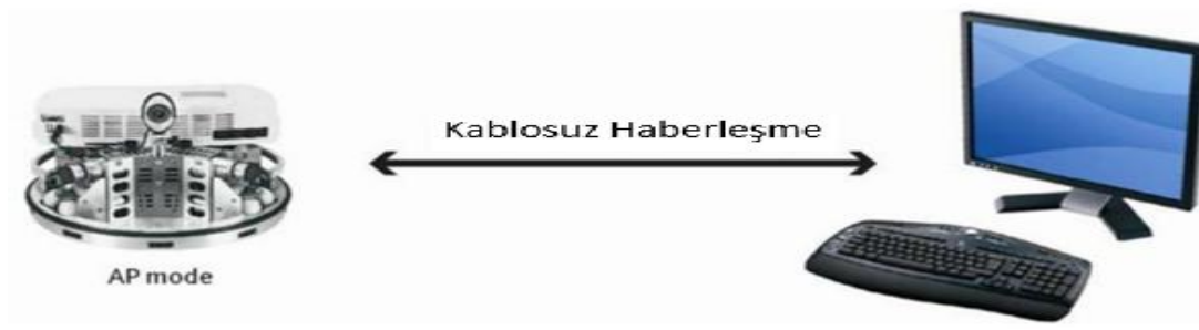
Şekil 3. 5 Robotino PC haberleşmesi
