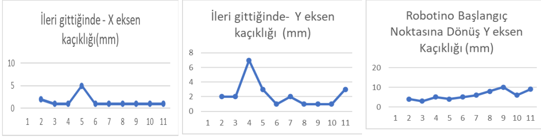
Şekil 4.7 Başlangıç noktasındaki y eksen kaçıklığı ve Robotino ileri gittiğindeki x ve y eksen kaçıklık ölçümleri
