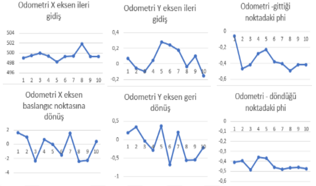
Şekil 4.8 İkinci 500mm ileri gidiş ve geri dönüş denemesi sırasında odometriden ölçülen x, y ve phi kaçıklıkları
