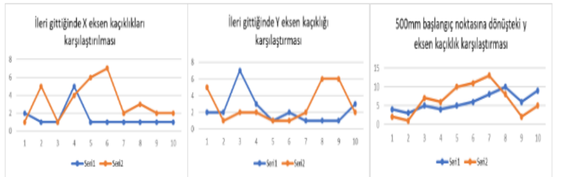
Şekil 4.11 İki deneme sonucunda Robotino mobil robottun eksen kaçıklık karşılaştırmaları
