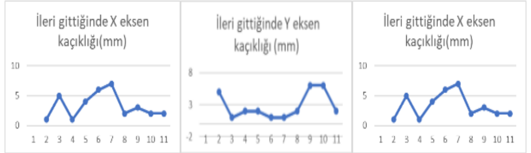
Şekil 4.9 Başlangıç noktasındaki y eksen kaçıklığı ve ileri gittiğindeki x ve y eksen kaçıklıkları
