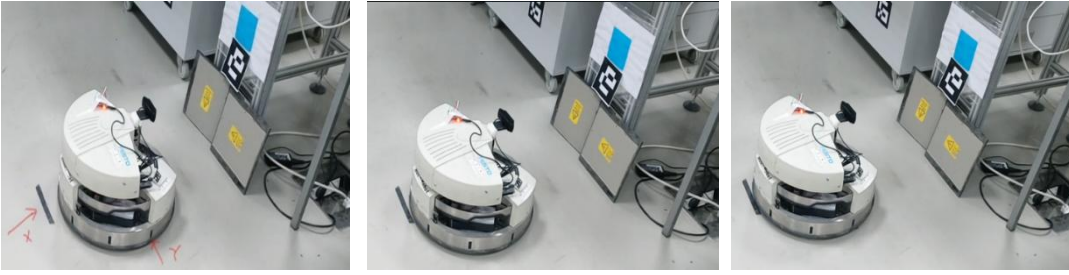
Şekil 4.23 İşaret algılayıcı ile hedef koordinata yönlendirme algoritması deneyi
