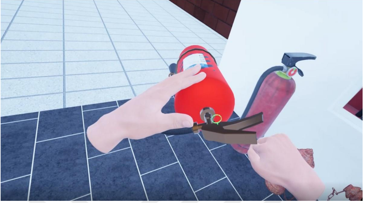
Şekil 3.27. Tüpün alınarak güvenlik Piminin sökülmesi
