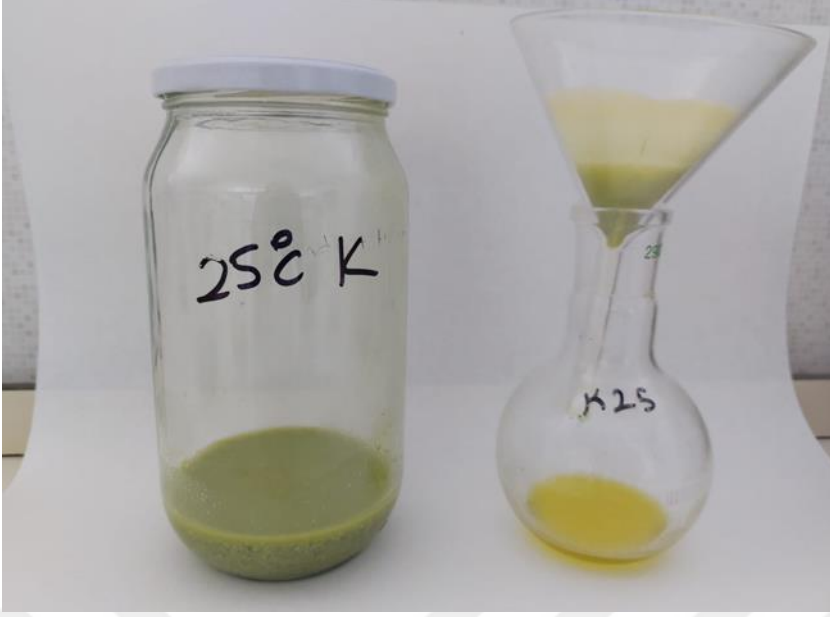
Şekil 3.13. Antep fıstığı tozu ve hekzanın filtre kağıdı ile süzülmesi
