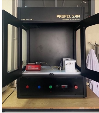
Şekil 5. Biyokompozit üretiminde kullanılan elektroğirme cihazı (Profelsan Prov-100, Türkiye).
