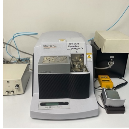
Şekil 9. Üretilen biyokompozitlerin termal karakterizasyonunda kullanılan DSC cihazı.
