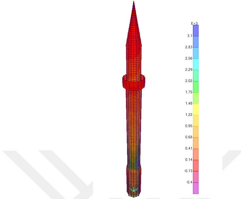
Şekil 6.70. 40 m lik minarede 2011 Van depremi için \sigma_{zz} normal gerilmeleri, Envelope max. (kPa)
