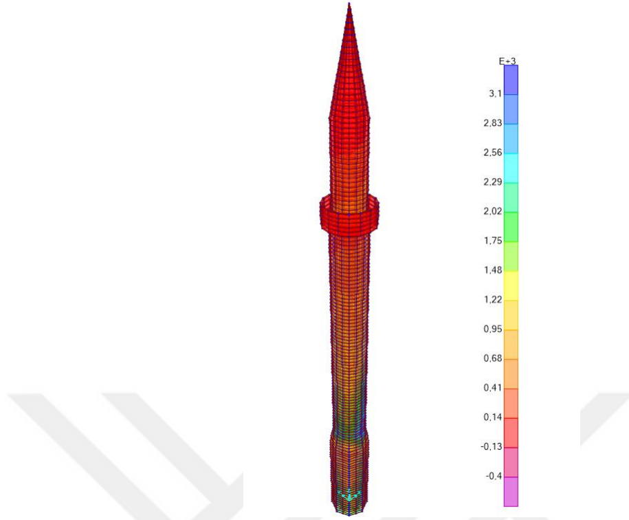
Şekil 6.49. 35 m lik minarede 2011 Van depremi için \sigma_{zz} normal gerilmeleri, Envelope max. (kPa)
