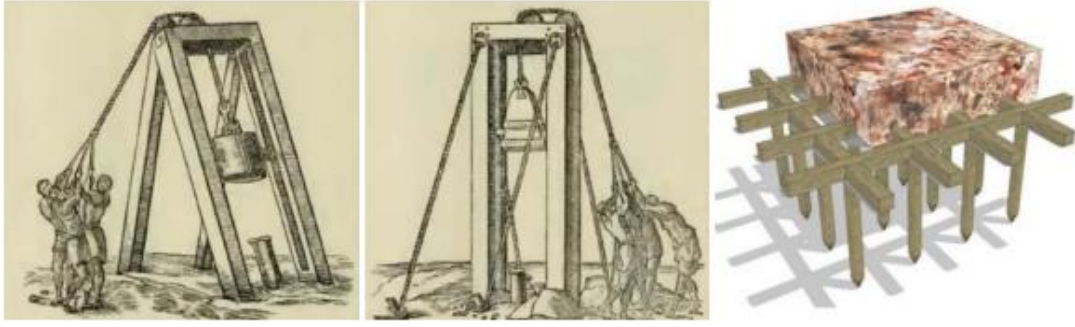
Şekil 3.1. Şahmerdan ile kazık çakımı, ahşap ızgara sistemi [43]
