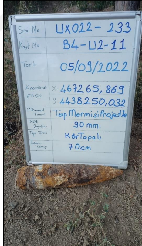
Şekil 5.1. B4 parselinde tespit edilen manyetik anomaliler sonucu bulunan bazı mühimmatlar.
