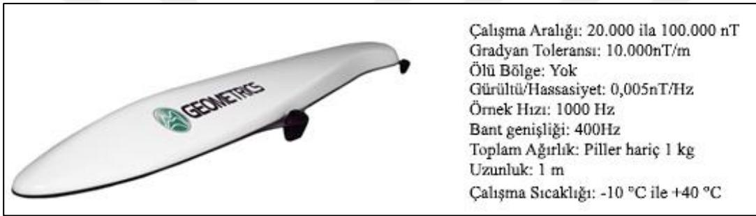
Şekil 2.17. Geometrics MagArrow manyetik sensörü.
