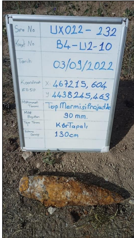
Şekil 5.1. B4 parselinde tespit edilen manyetik anomaliler sonucu bulunan bazı mühimmatlar.
