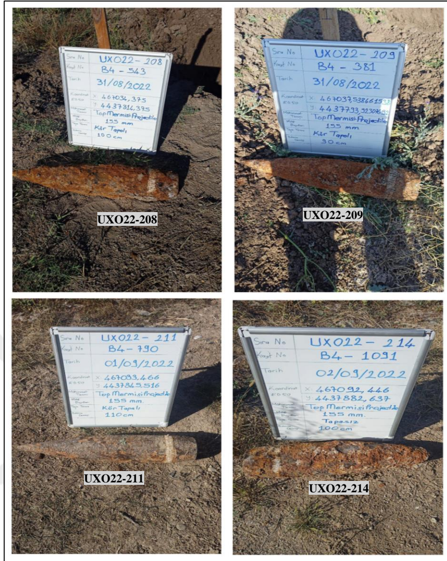
Şekil 5.4. B4 parselinde tespit edilen 155 mm uzunluğundaki mühimmatların fotoğrafları-1.
