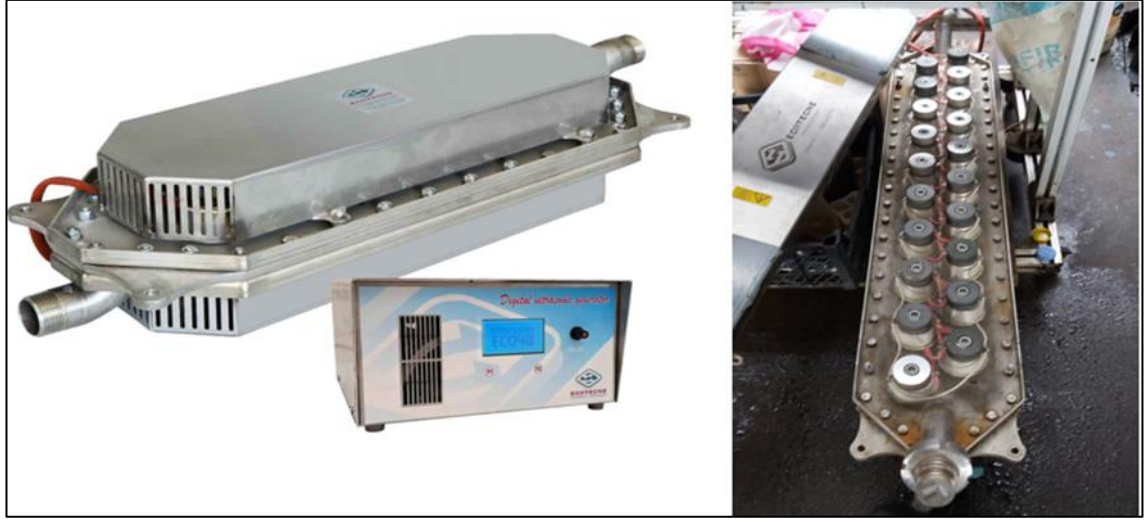
Şekil 3.3. Radyal etkili sürekli ultrases sistemi
