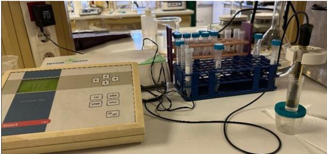
Resim 3.8. İyon analiz cihazı (Consort C863 Multi - parameter analyser, Parklaan, Belçika) ve bağlı iyon spesifik elektrot (PerfectION comb. PB Combined Ion-selective electrode, Mettler Toledo, İsviçre)
