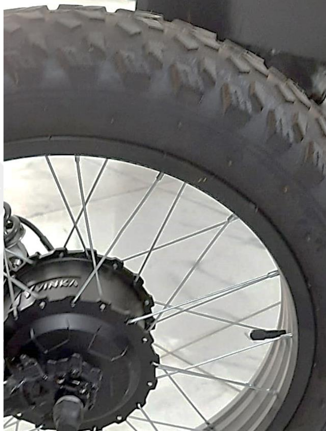
Şekil 3.2.6.2. Skuterde kullanılmış olan arka tekerlek ve motor
