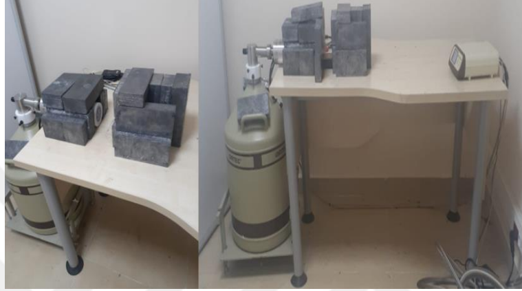
Şekil 3.4. Gama ışını zırhlama parametrelerini elde etmek için kullanılan deneysel düzeneği
