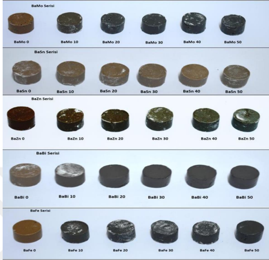
Şekil 3.2. Hazırlanan barit tabanlı üçlü polimer kompozit malzemeler
