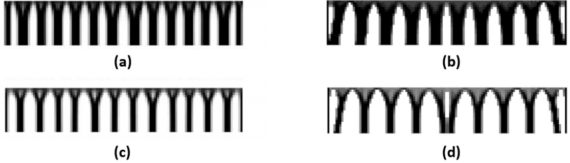
Şekil 4.13. Topoloji optimizasyonu sonuçları: (a) referans problem için V_f = 0.6 sonucunu, (b) bu çalışmanın V_f = 0.6 sonucunu, (c) referans problem için V_f = 0.4 sonucunu, (d) bu çalışmanın V_f = 0.4 sonucunu göstermektedir.
