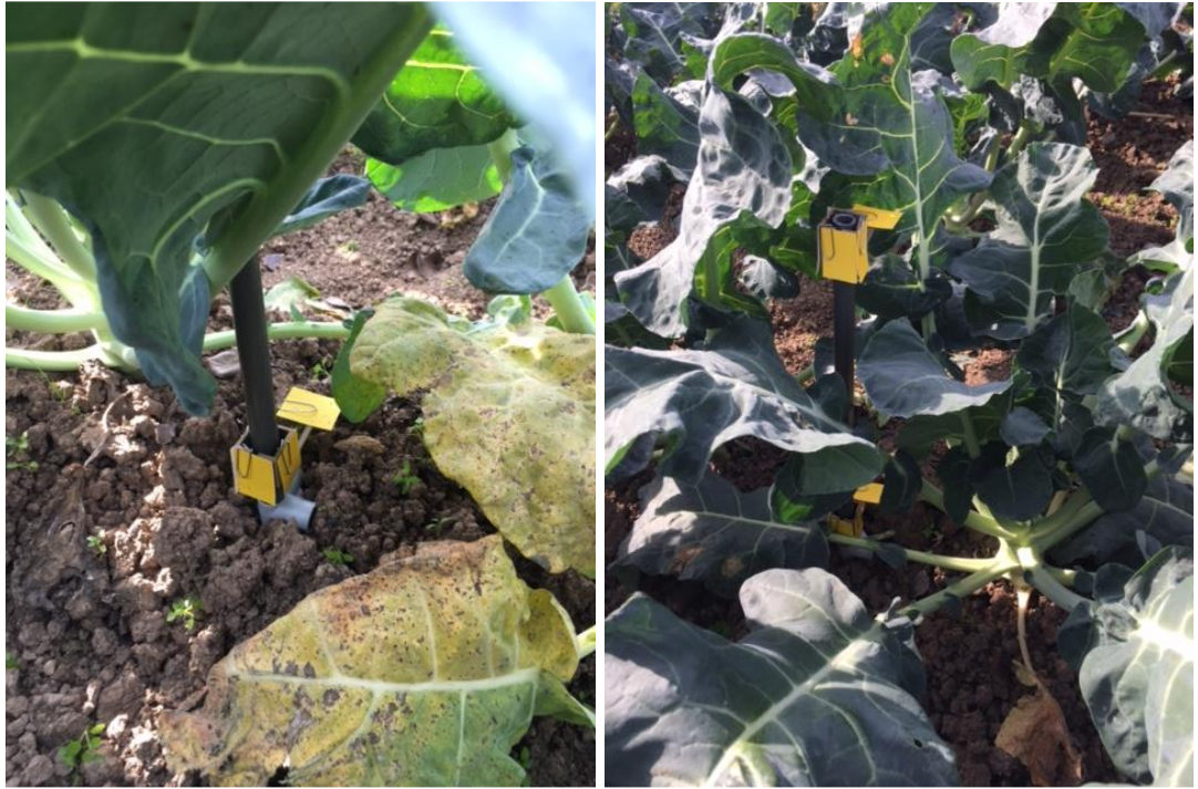
Şekil 3.58. Örnekleme direklerinin bitki kanopisine yerleştirilmesi
