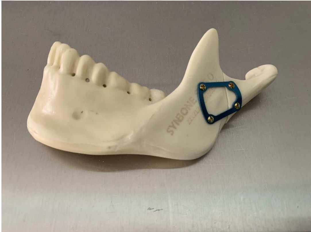
Şekil 2.3. 0.7 mmlik plakla fiksasyonu gerçekleştirilmiş model örneği
