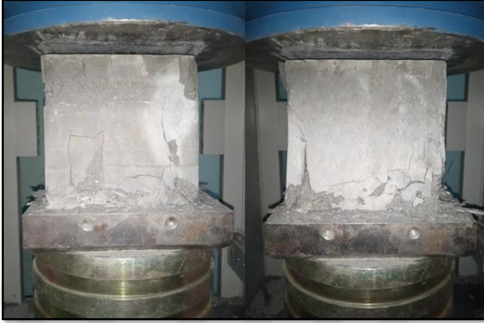
Şekil 3.16. Deforme olmuş basınç dayanımı testi numuneleri
