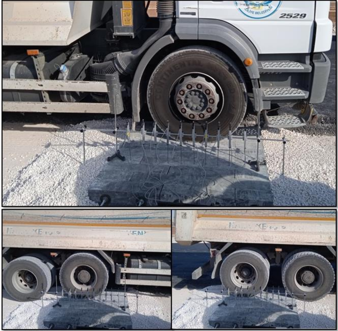
Şekil 3.21. Damperli kamyonun hareket halinde iken modüler beton yol kaplama üzerindeki durumu
