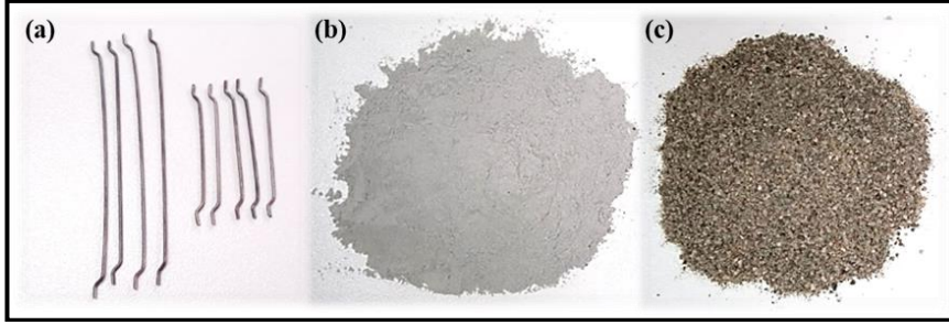
Şekil 3.1. Çelik lif (a), silis dumanı (b), doğal kum (c)
