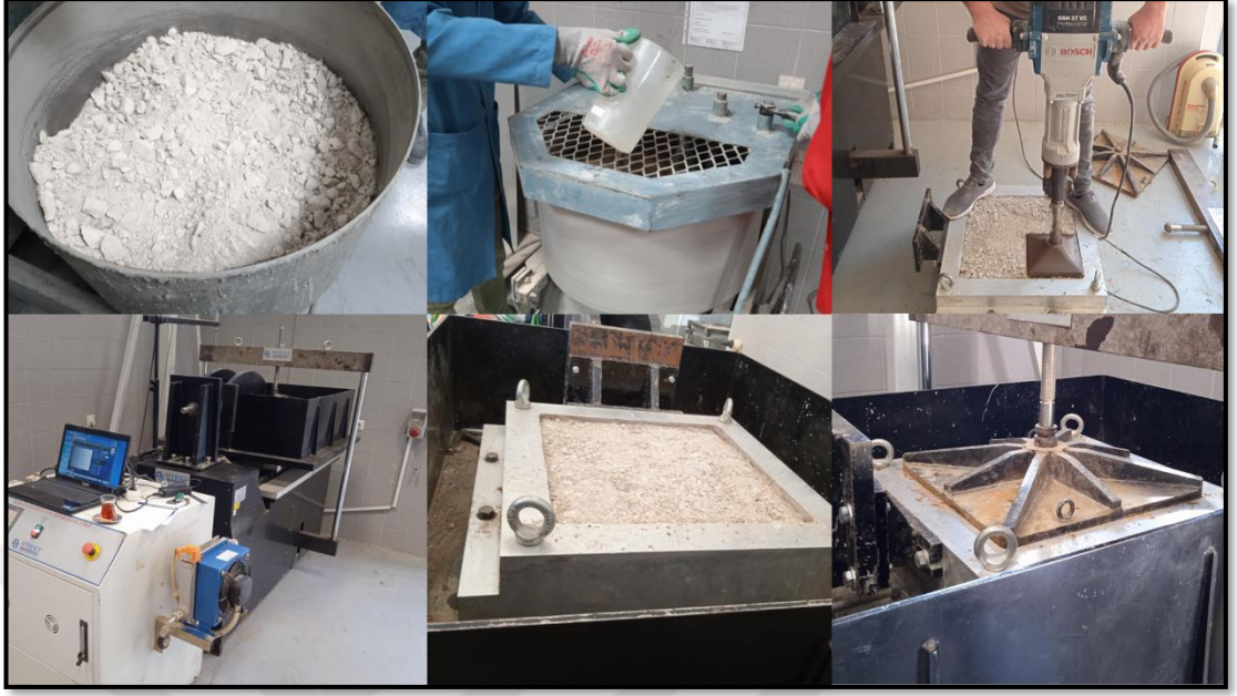
Şekil 3.26. Büyük ölçekli kesme kutusu testi
