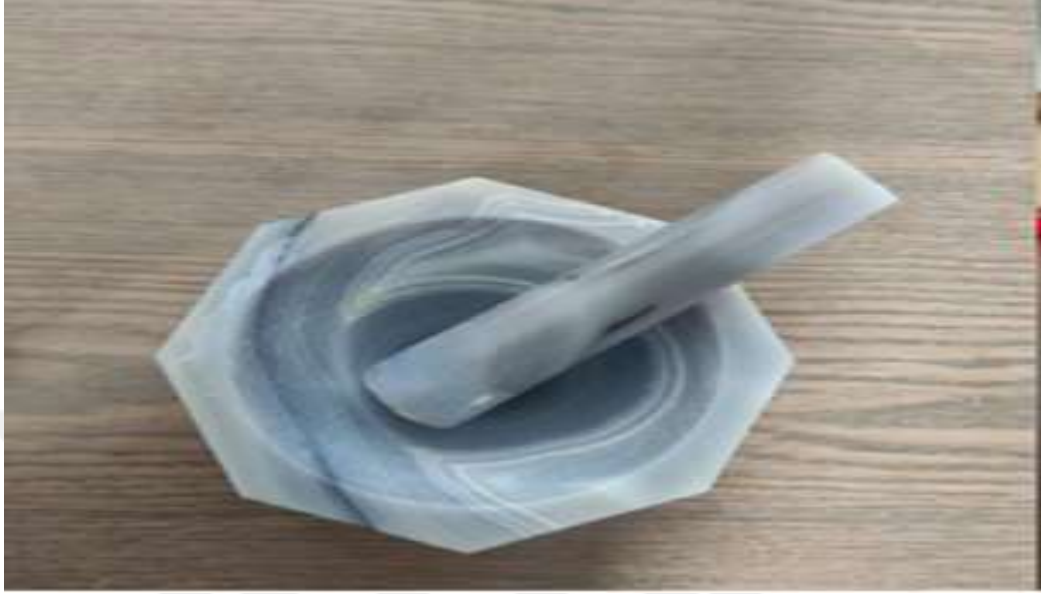
Şekil 2.3. \text{Bi}_{2.0-x}\text{Y}_x\text{Sr}_{2.0}\text{Ca}_{1.1}\text{Cu}_{2.0}\text{O}_y seramik materyal üretiminde kullanılan havan takımı
