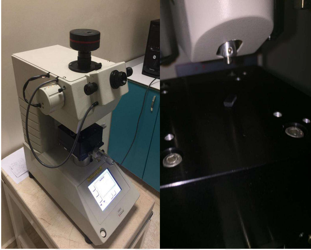
Şekil 2.6. a) SHIMADZU HVM-2 model dijital mikrosertlik cihazı ve b) arayüzü
