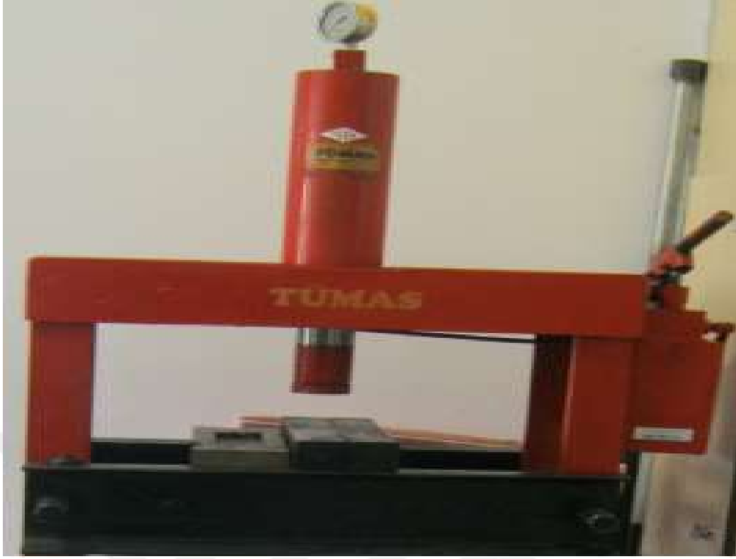
Şekil 2.5. TSEK TUMAS manuel hidrolik pres
