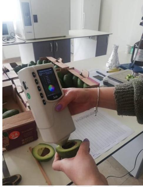
Fotoğraf 3.8 El tipi kolorimetre ile renk ölçümü
