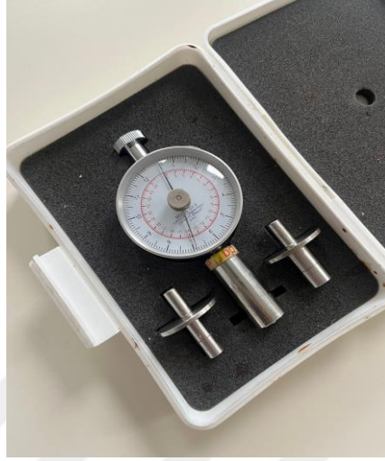
Fotođraf 3.5 Meyve Eti Sertliđi Ölçüm Cihazı (penetrometre)
