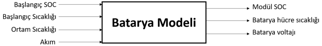
Şekil 3. 11. Batarya simülasyon modelinin ana girdi ve çıktıları
