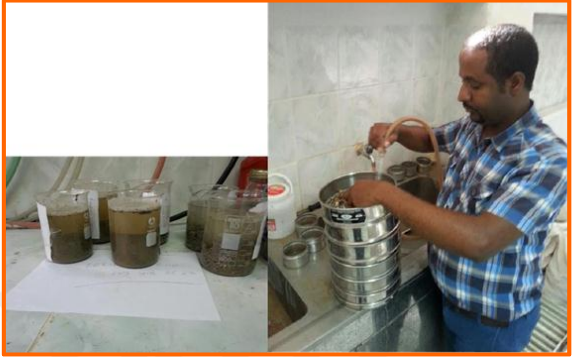
Şekil 7.5 Elek analizi çalışmaları
