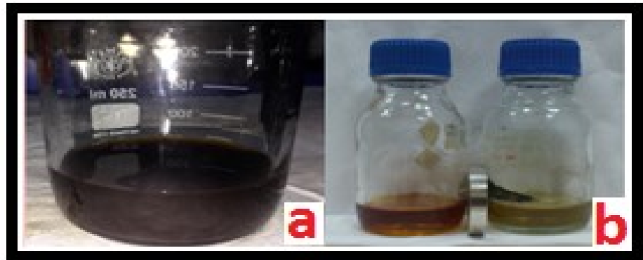
Şekil 4.2. Manyetik nanopartiküllerin çözelti ortamından mıknatıs yardımıyla ayrımı.
