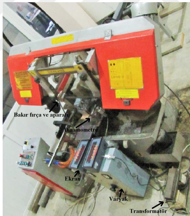
Şekil 4.1. Elektrik akımı kullanarak ısıtma ile testerede imalat uygulaması
