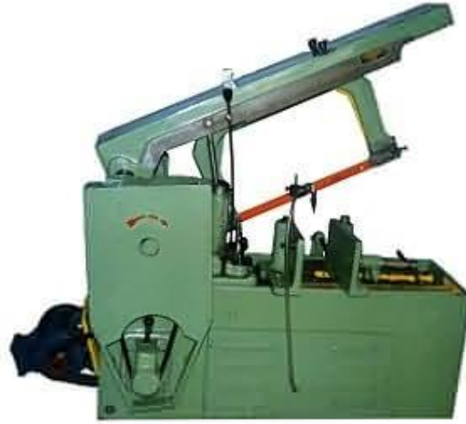
Şekil 3.1. Kollu testere tezgahı(Anonim,2016)
