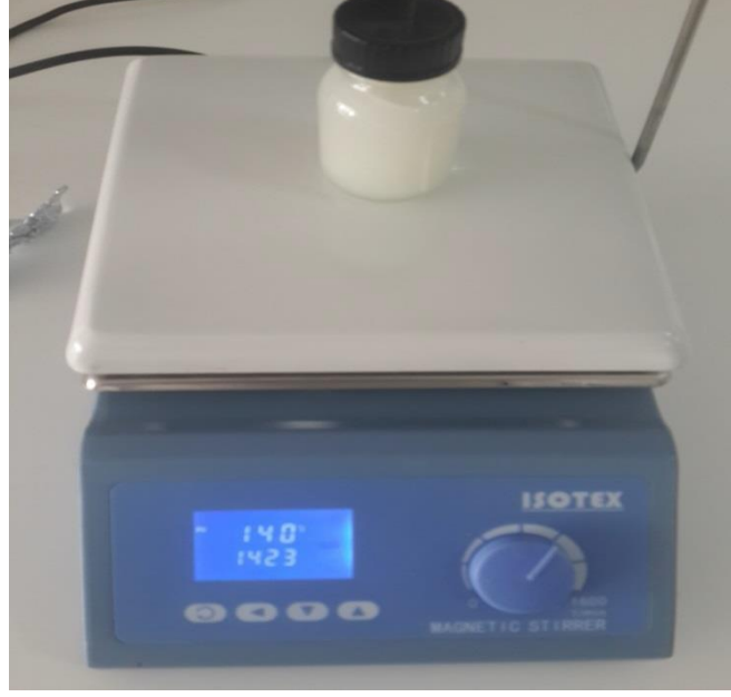
Şekil 13: Çalışmada kullanılan PHB'nin kloroform içinde çözündürülmesi.
