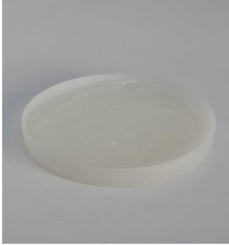
Şekil 15: Çeker ocaktaki PHB'den kloroformun uzaklaştırılması.
